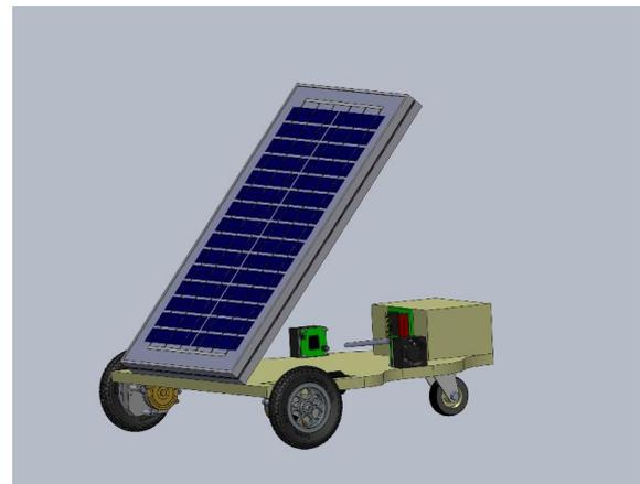
fig 2: Modèle CAO du chariot autonome
