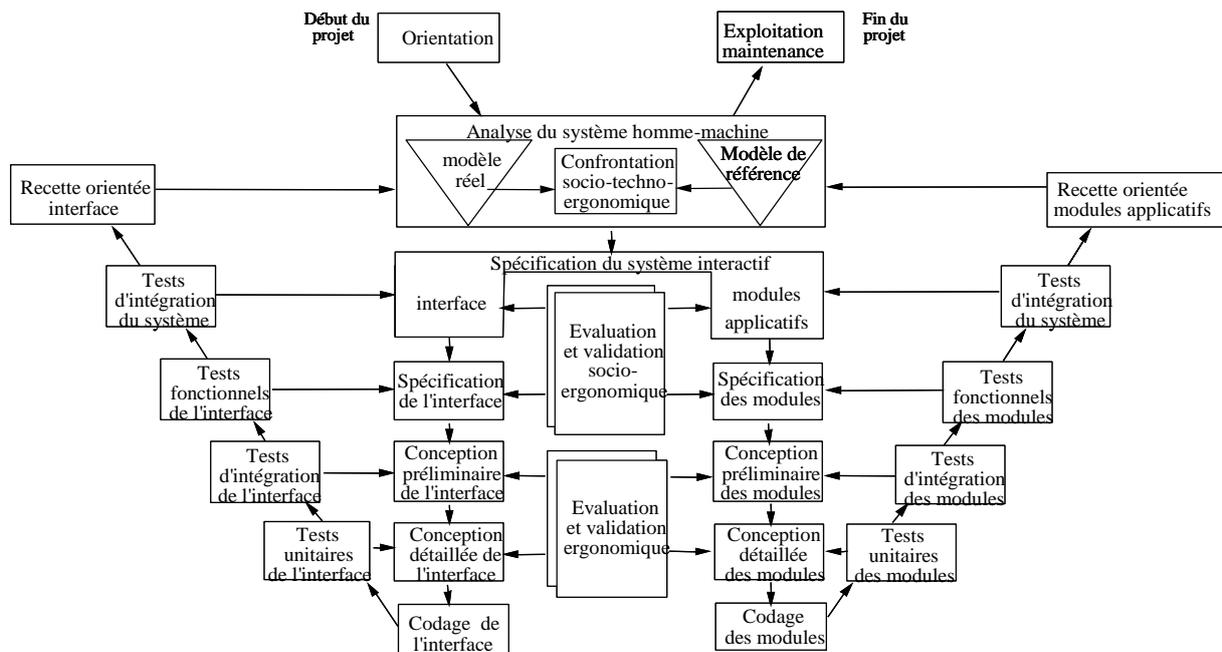
**Figure 1.** Exemple de modèle enrichi sous l'angle des interactions homme-machine
