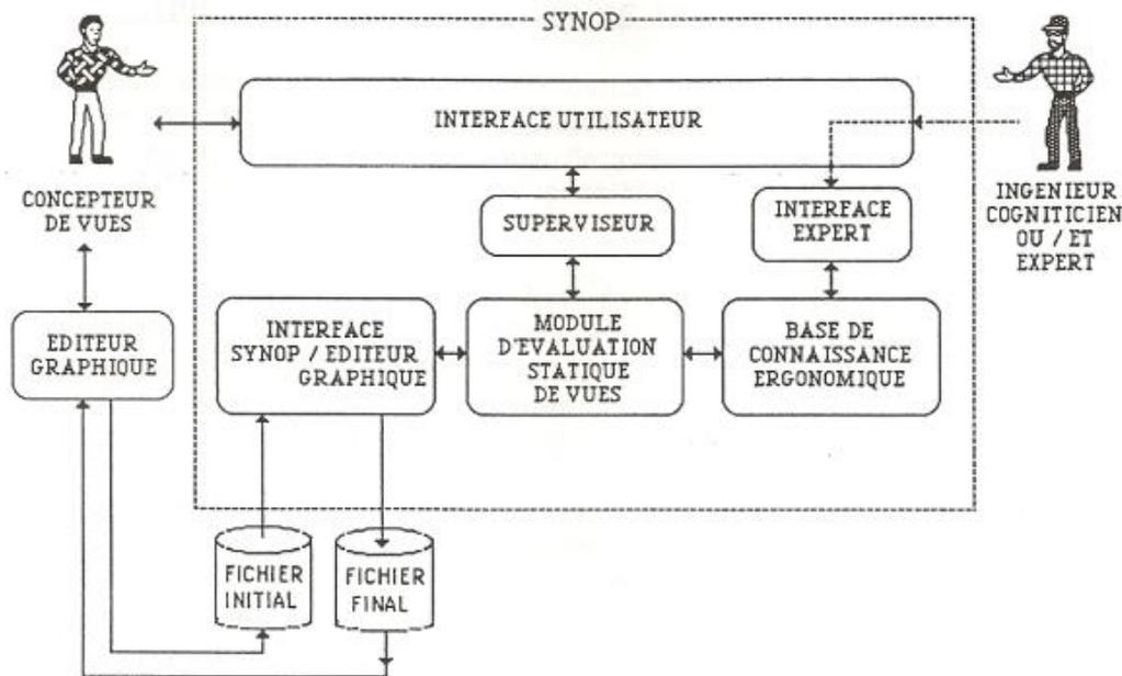
Figure 1 : Architecture logicielle de SYNOP
