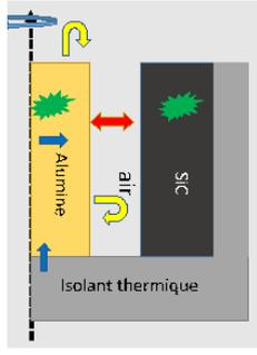
Figure 2 : Types d'échanges thermiques sur l'échantillon
