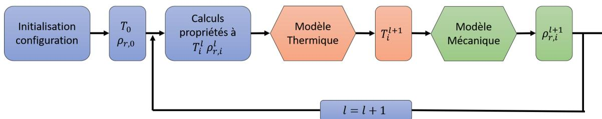
Figure 4 : Schéma du processus du couplage thermomécanique
