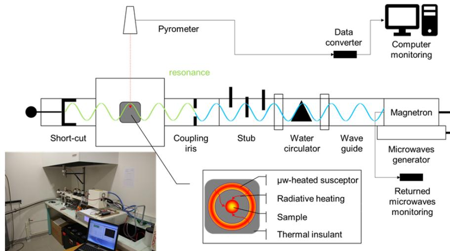
Figure 1 : Dispositif de frittage par micro-ondes utilisé pour les expérimentations, crédit : Anthony Thuault.
