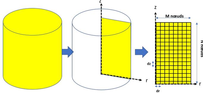
Figure 3 : Discrétisation de l'échantillon à partir d'une tranche
