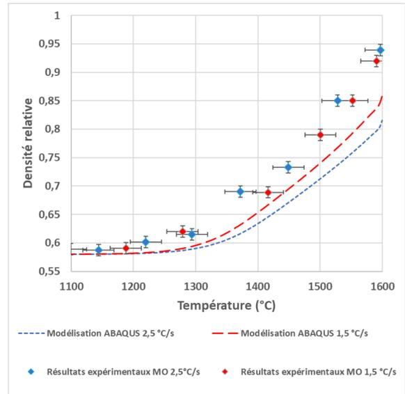
Figure 8 : Comparaison des résultats modélisés et expérimentaux par micro-ondes
