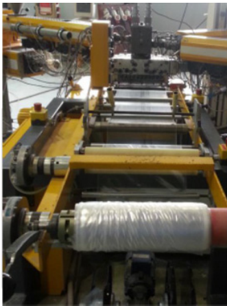
Figure 11. Mise en forme des films bio-sourcés piezoelectriques.
