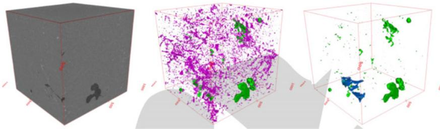
Figure 6. Reconstruction microtomographique d'un alliage AlSiCu avec au centre, les intermétalliques, à droite, les porosités.
