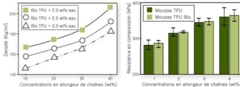
**Figure 3.** Effet des concentrations en allongeur de chaînes et en agent d'expansion sur la masse volumique des mousses polyuréthanes bio-sourcées. Comparaison des propriétés mécaniques en compression de mousses de polyuréthanes bio et non bio-sourcés.
