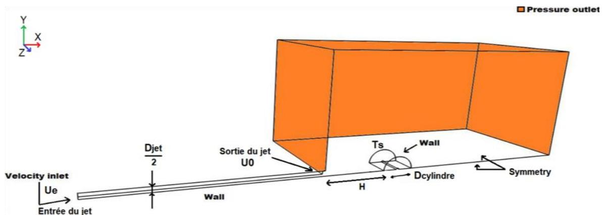
Figure 2: Modèle numérique avec conditions aux limites
