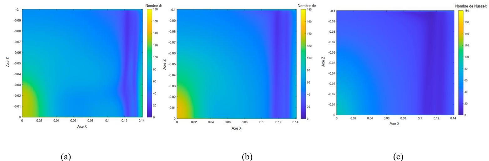
Figure 8 : Cartographie du nombre de Nusselt pour le quart de cylindre étudié pour  $D_{\text{cylindre}}/D_{\text{jet}} = 2$ , (a)  $h/D_{\text{jet}} = 2$  ; (b)  $h/D_{\text{jet}} = 5$  ; (c)  $h/D_{\text{jet}} = 8$
