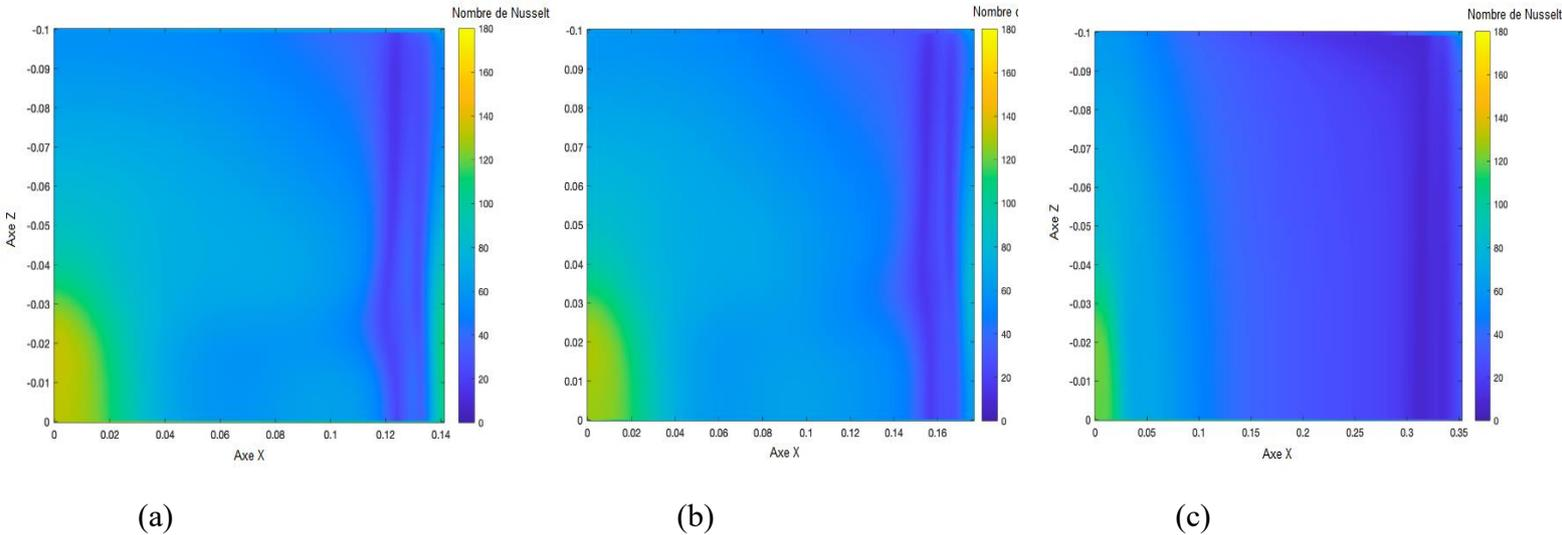
Figure 7 : Cartographie du nombre de Nusselt pour le quart de cylindre étudié pour  $h/D_{\text{jet}} = 2$ , (a)  $D_{\text{cylindre}}/D_{\text{jet}} = 2$ , (b)  $D_{\text{cylindre}}/D_{\text{jet}} = 2,5$ , (c)  $D_{\text{cylindre}}/D_{\text{jet}} = 5$
