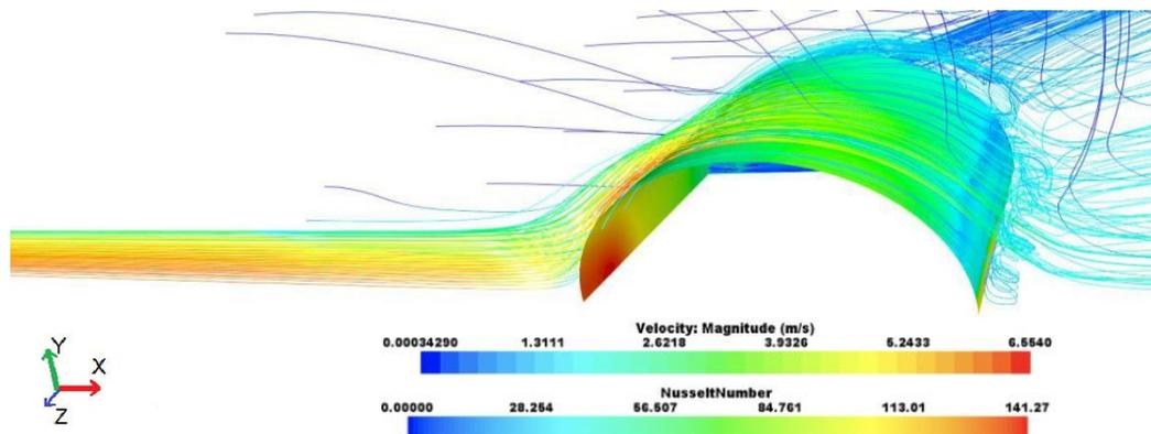
Figure 6: Visualisation des lignes de courants en aval du cylindre
