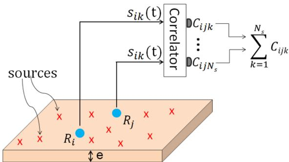
Fig 1: Reconstruction des FG par corrélation de bruit.
