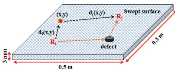
Fig 2: Principe de l'algorithme d'imagerie.
