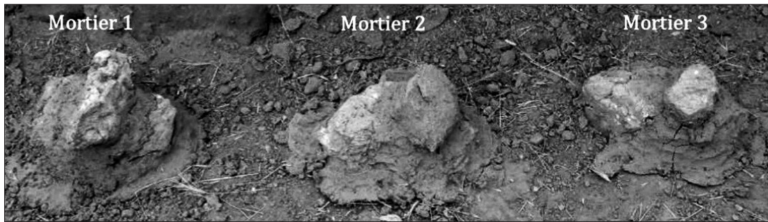
Fig. 29 Tests de mortier de rejointoiement (© CRAterre_C. Sadozaï 2022).
