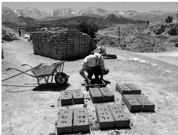
Fig. 26 Production expérimentale de briques crues (© CRATerre_C. Sadozaï 2022).
