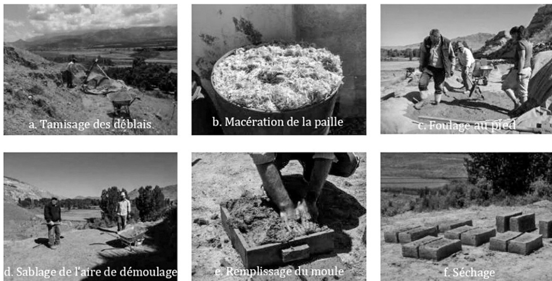
Fig. 28 Étapes de la production de briques crues 2022 [© CRAterre_C. Sadozai 2022 (a--d--e--f)/ Mission Porsuk--Zeyve Höyük (b--c)].
