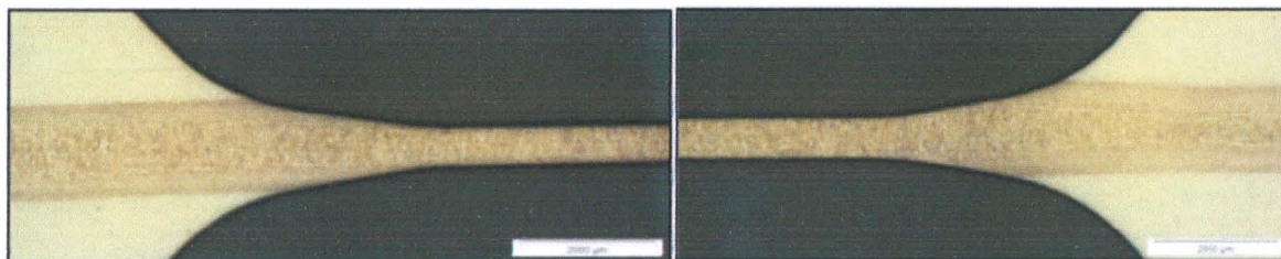
Figure 37 : « Mini-spécimen » utilisé pour la caractérisation des propriétés mécaniques du cordon de soudure
