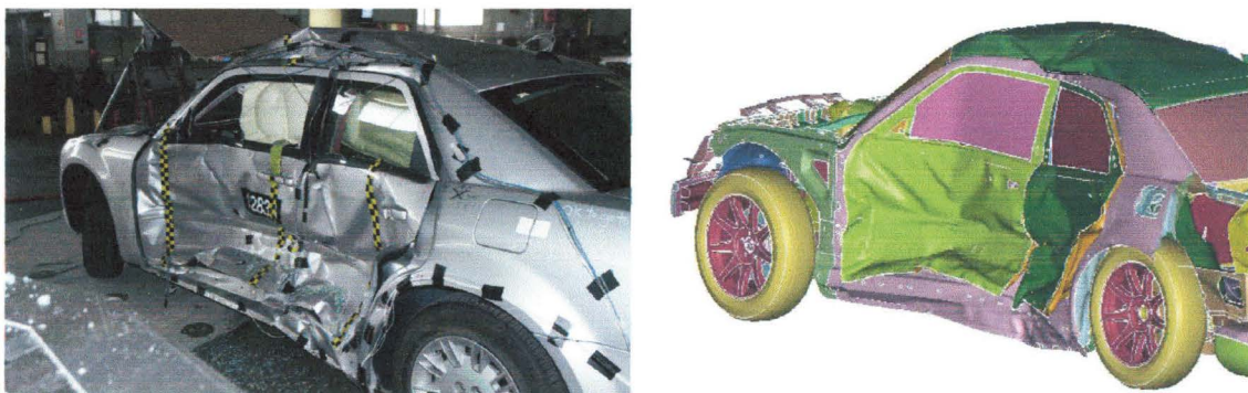
Figure 1 : Comparaison visuelle entre une déformée résultant d'une expérience réelle (gauche) et l'autre émanant de la simulation (droite)
