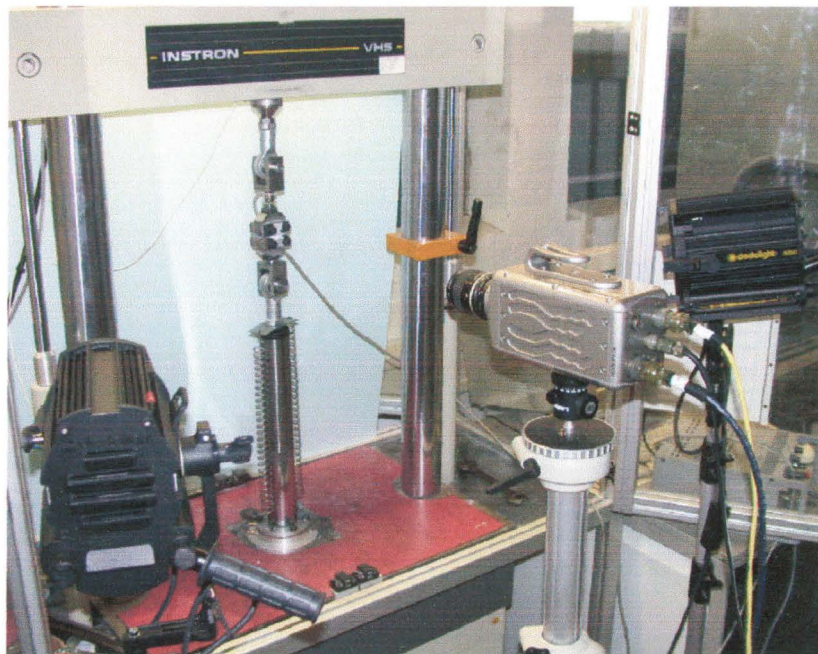
Figure 83 : Installation expérimentale complète dans le cas des chargements dynamiques
