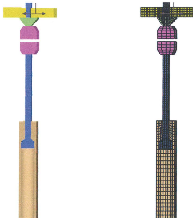
Figure 51 : Modèle détaillé du dispositif expérimental proposé par IWM (Freiburg)
