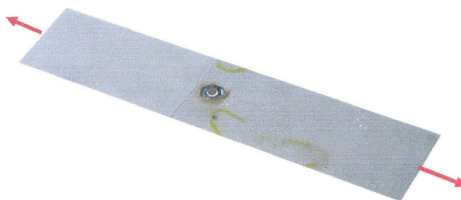
Figure 22 : Spécimen de type « Lap-Shear » et son chargement associé (flèches rouges)
