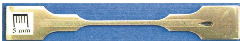
Figure 34 : « Mini-éprouvette » de traction utilisée pour la caractérisation mécanique de la zone affectée thermiquement et du cordon de soudure dans le cas de la technologie « RobScan »
