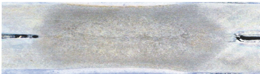
Figure 28 : Coupe transversale d'une soudure par point – Assemblage HT700TD 1,25 mm / HT700TD 1,25 mm
