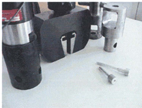
Figure 43 : Mors utilisés pour les essais sur spécimens de type « Lap-Shear »
