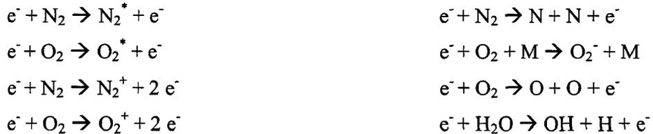
N<sub>2</sub><sup>\*</sup> et O<sub>2</sub><sup>\*</sup> représentent les formes excitées des molécules de N<sub>2</sub> et d'O<sub>2</sub>. Ce sont des états métastables.
