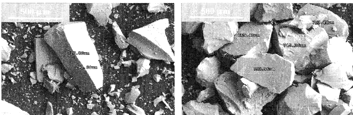
Figure 26 : Micrographie MEB de la poudre de verre concassée puis tamisée à 800 \mu\text{m} .
