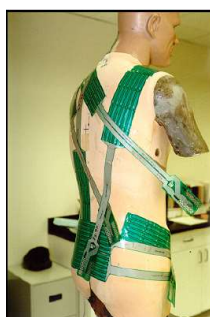
Figure V.6 : système F-Scan de mesure des pressions. (d'après Bossi et al., 2001)
