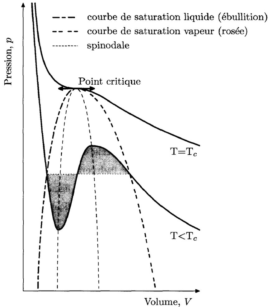
FIG. I.2 – Diagramme de Clapeyron
