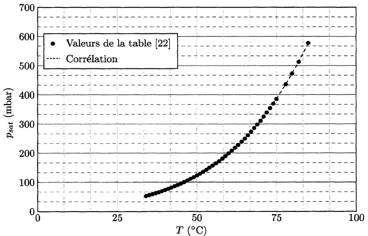
FIG. I.5 – Évolution de la pression de saturation avec la température.
