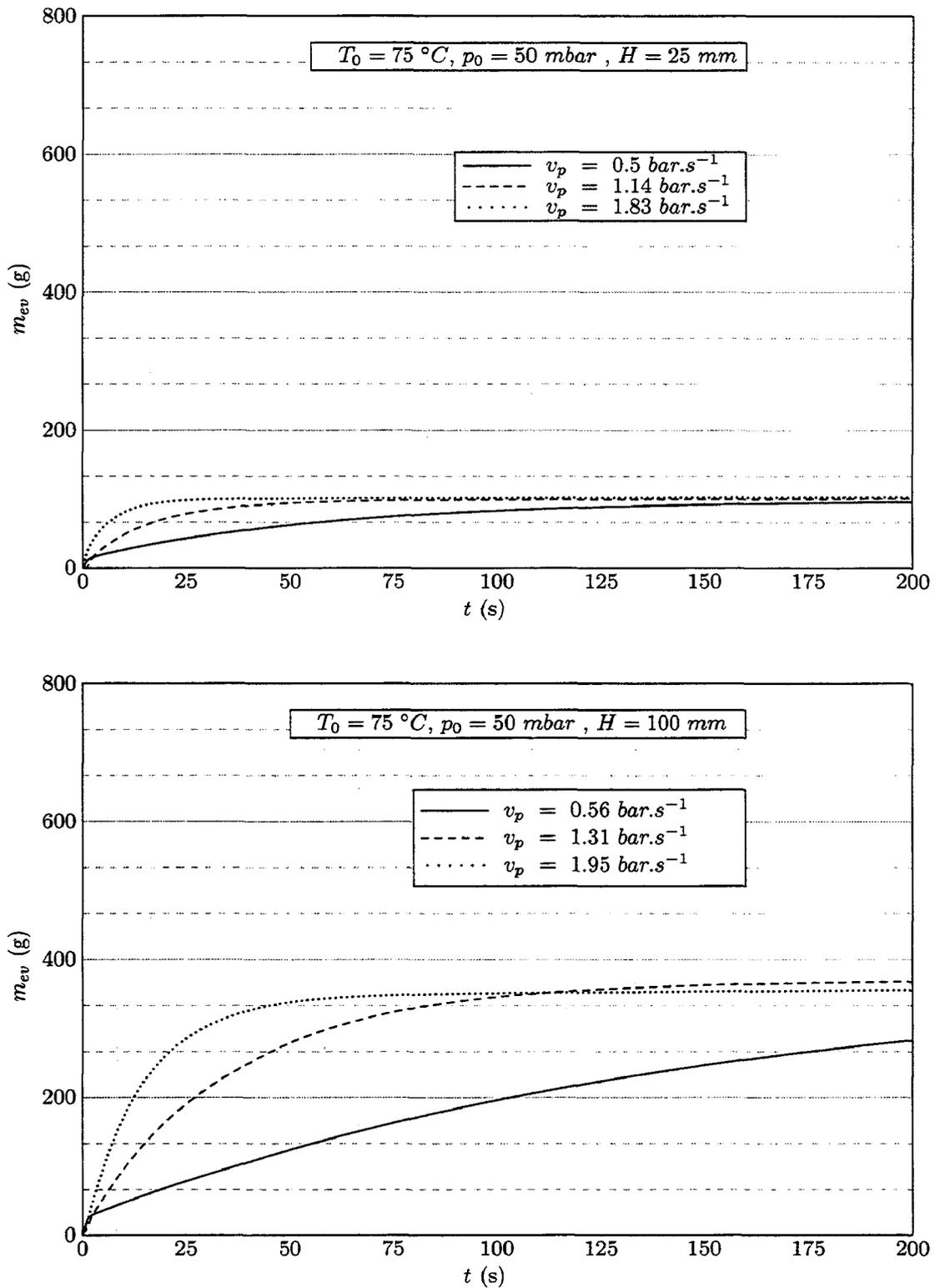
FIG. III.34 – Évolution de la masse évaporée en fonction du temps pour  $T_0 = 75\text{ °C}$  et  $p_0 = 50\text{ mbar}$  (suite)
