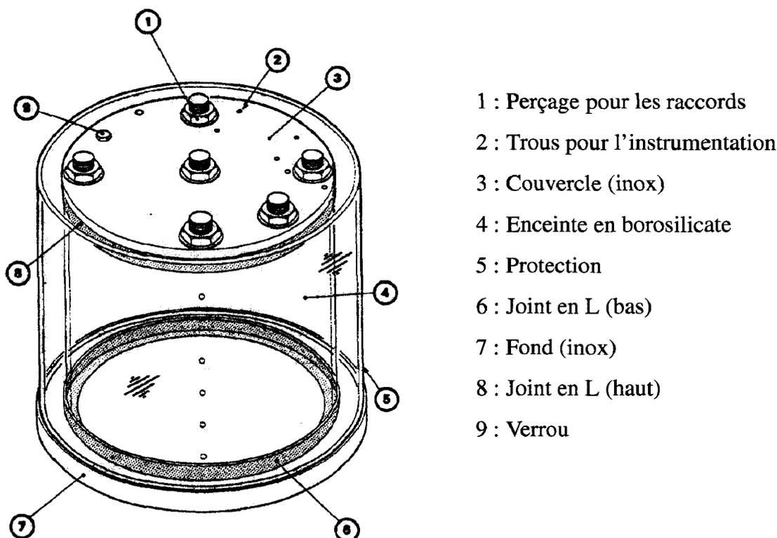
FIG. II.5 – L'enceinte et sa protection.
