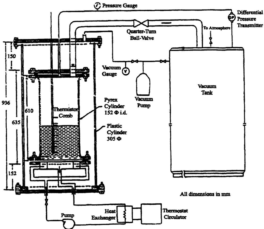
FIG. I.13 – Schéma descriptif du dispositif utilisé par Gopalakrishna [16]
