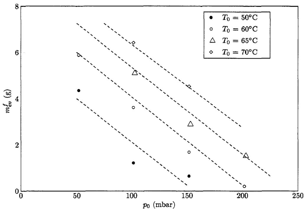
FIG. III.6 – Évolution de  $m_{ev}^f$  en fonction de la pression
