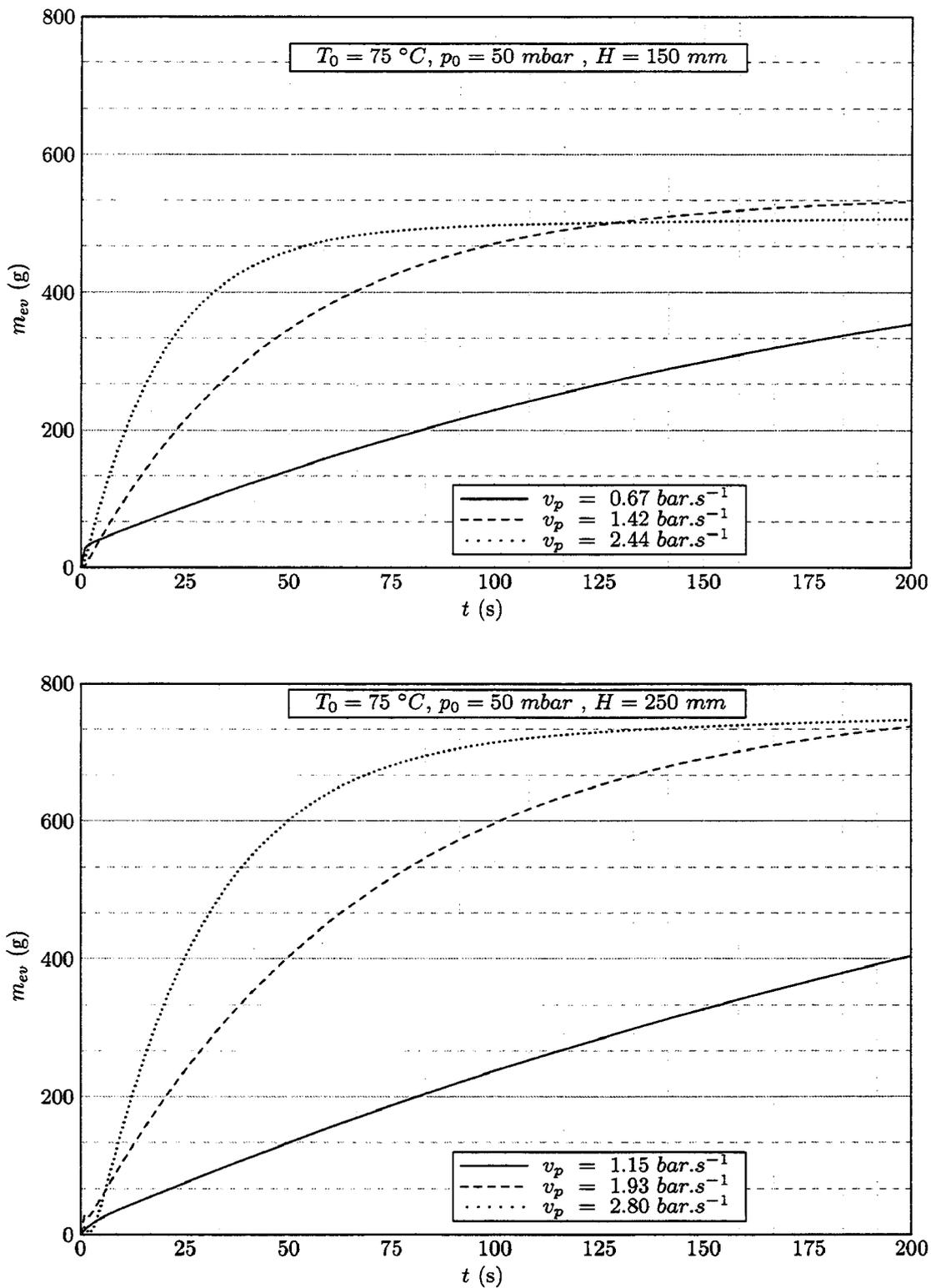
FIG. III.34 – Évolution de la masse évaporée en fonction du temps pour  $T_0 = 75\text{ }^\circ\text{C}$  et  $p_0 = 50\text{ mbar}$  (suite)
