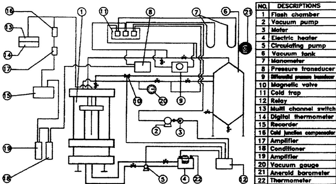
FIG. I.14 – Schéma descriptif du dispositif utilisé par Kim [33]
