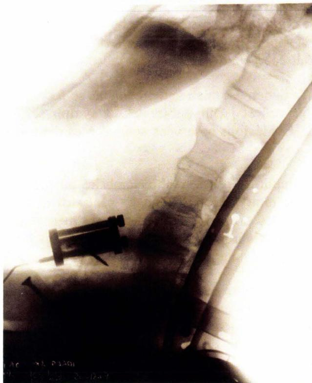
Figure 245. Radiographie d'un rachis lombaire après essai sur catapulte.
