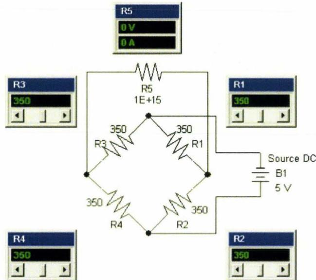
*Simulation d'un pont équilibré, (Circuit-shop 2006).*
