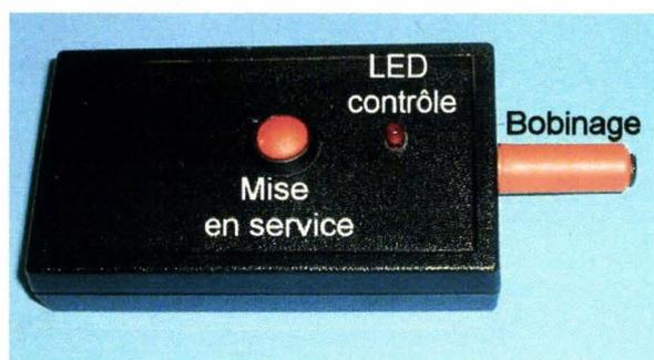
Figure 172. Circuit émetteur.
