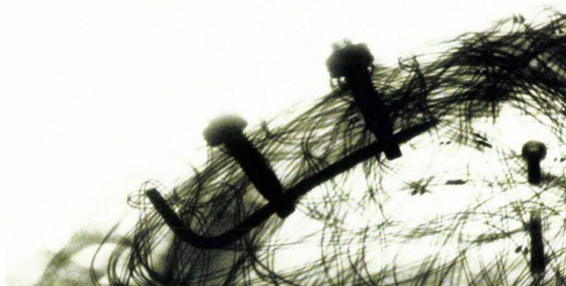
*Figure 154. Radiographie de profil de l'instrumentation installée sur le manubrium.*
