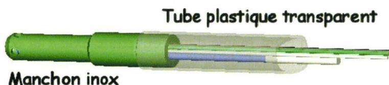
Figure 30. CAO du capteur équipé de sa gaine en plastique transparent montée sur le manchon
