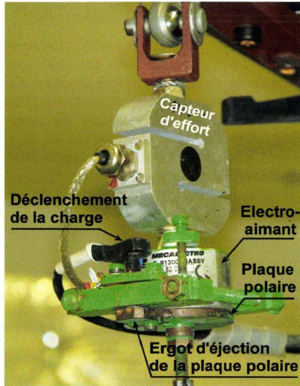
Figure 44. Capteur d'effort, électro-aimant, plaque polaire, charge pyrotechnique.
