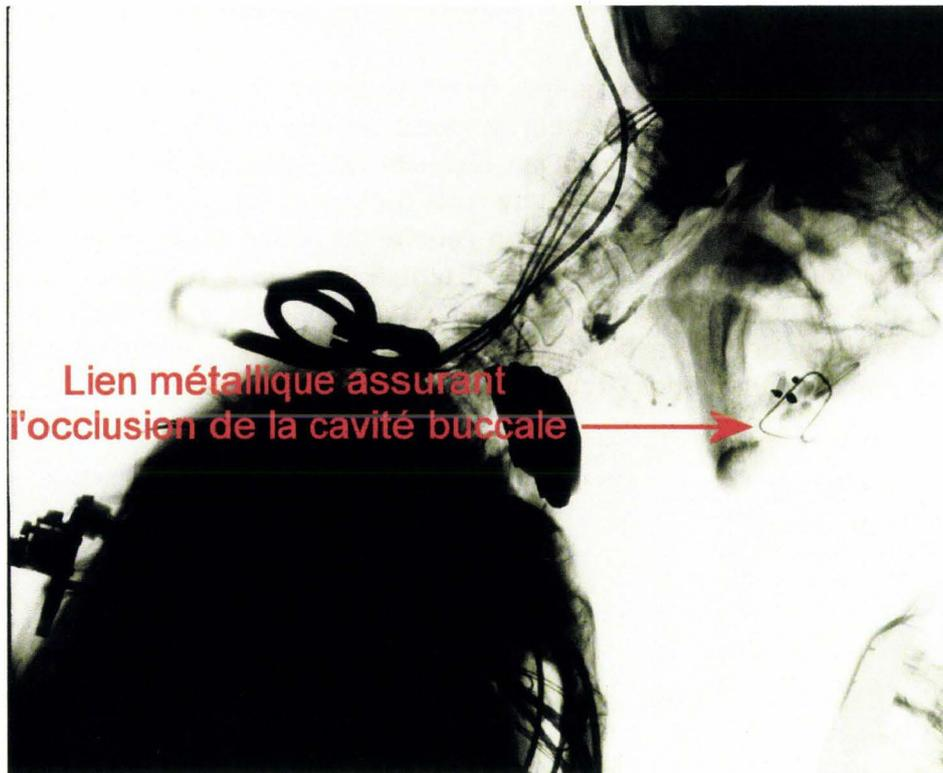
Figure 13. Radiographie de profil d'un sujet positionné devant un chargement frontal par coussin gonflable impliquant la tête et le cou.
