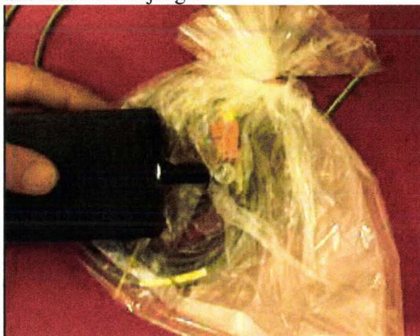
Figure 173. Alignement de la bobine émettrice avec la bobine réceptrice.
