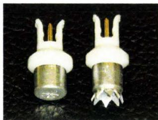
Figure 43. Charge pyrotechnique utilisée pour l'éjection des plaques polaires. Specimen neuf à gauche. Specimen après mise à feu à droite.
