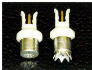
Figure 43. Charge pyrotechnique utilisée pour l'éjection des plaques polaires. Spécimen neuf à gauche. Spécimen après mise à feu à droite.
