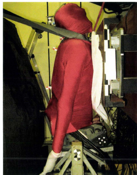
Figure 185. Vue de profil montrant le sujet quasiment en contact avec le coussin gonflable.
