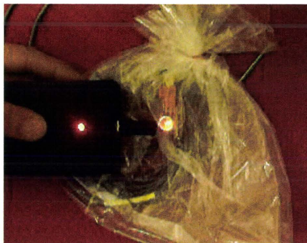
Figure 174. Allumage de la LED du circuit de réception à l'intérieur du sac en plastique.
