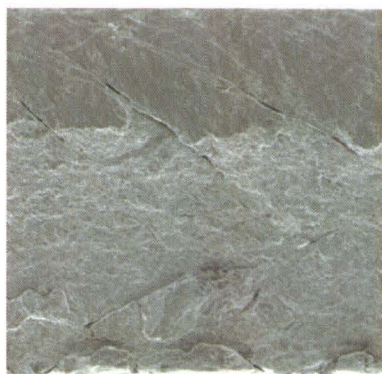
rive fissurée en deuxième passe de déformation avec l'URT
