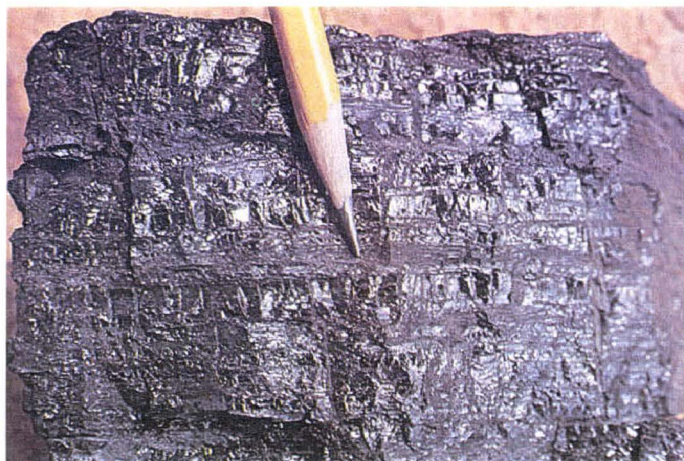
FIGURE 1.7 – Litage d'un bloc de charbon (Image par West Virginia Geological and Economic Survey)
