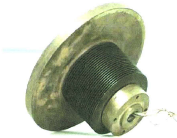
FIGURE 3 – Disque de frein caloduc
