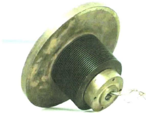
FIGURE 3 – Disque de frein caloduc
