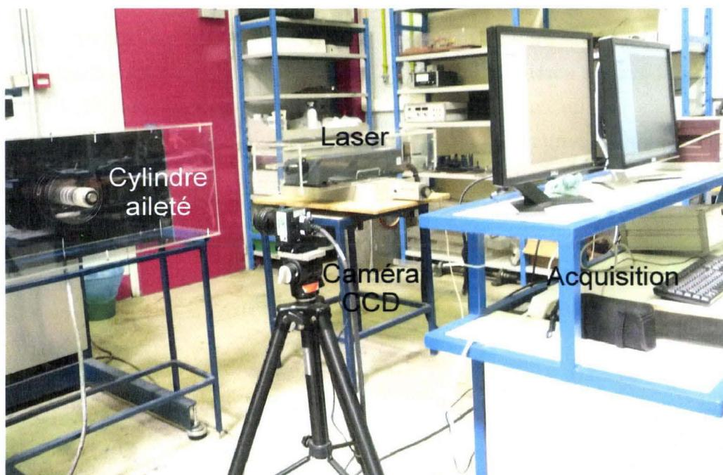
FIGURE 3.9 – Photo de la maquette PIV
