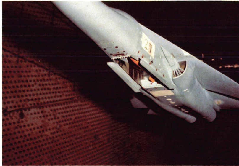
Figure 1.23 – Contrôle passif à l'aide d'un déflecteur en dents de scies (Clark [22])
