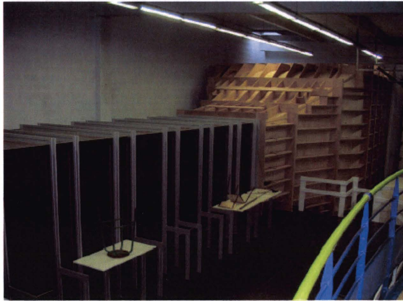
Figure 2.13 – Photo du convergent et d'une partie de la veine d'essais de la soufflerie
