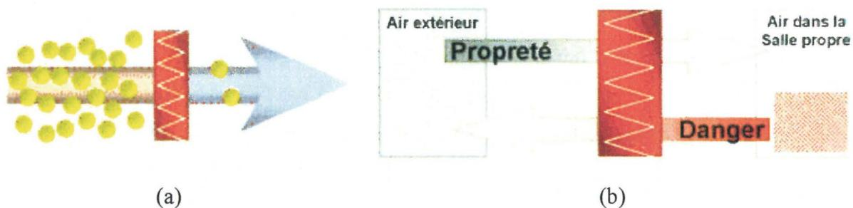
**Figure I-7:** a) Filtration à sens unique ; b) Filtration dans les deux sens
