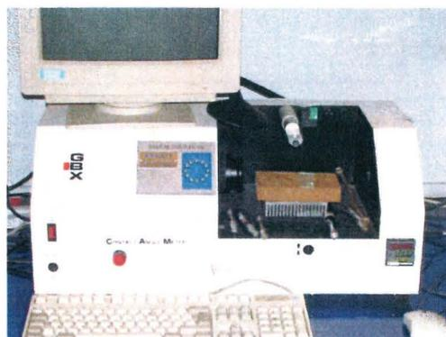
**Figure II-19:** Appareil de mesure Digidrop (GBX)
