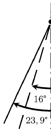
FIG. 4.3 – Angle par rapport à l'axe vertical de la force de réaction sous les mains pendant des mouvements de transfert. Transferts latéraux mesurés, en trait plein, et transfert oblique de Gagnon et coll. (2008b), en tirets.
