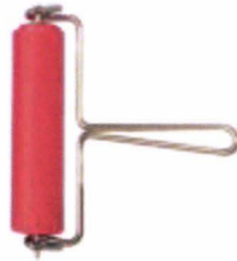
Figure 2-10: Rouleau encreur en polyuréthane pour l'application de l'huile
