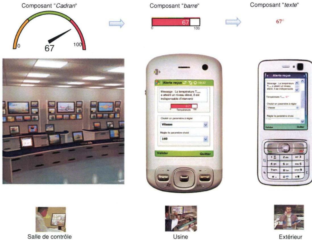
Figure IV.96 : IHM adaptée pour un PDA, régénération pour un téléphone portable
