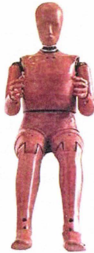
Fig. 2 : Mannequin HYBRID III utilisé pour les essais de crash-tests frontaux
