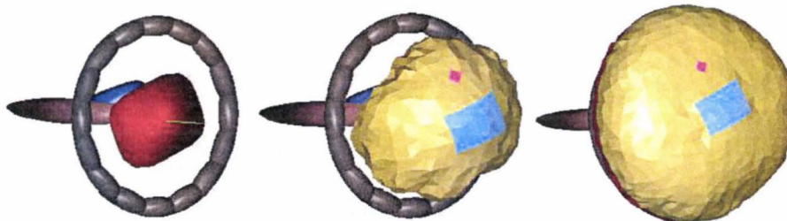
Fig. 28 : Exemple de déploiement d'un airbag numérique
