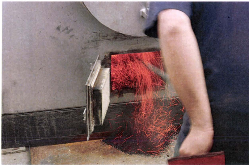
Figure 6-7 : Cendres de bois recueillies en sortie de four
