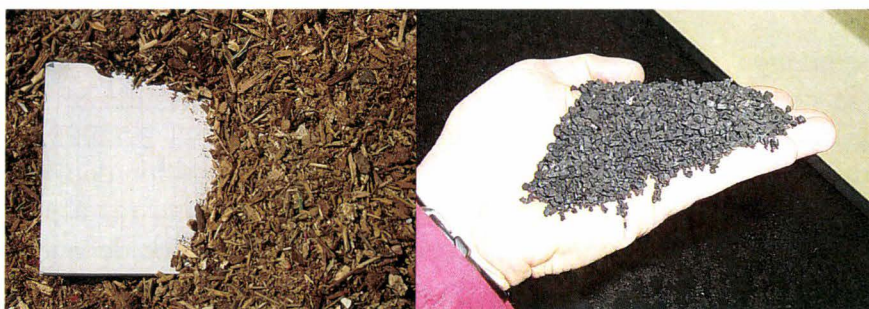
Figure 6-1 : Photos d'échantillons de bois et pneu broyés utilisés
