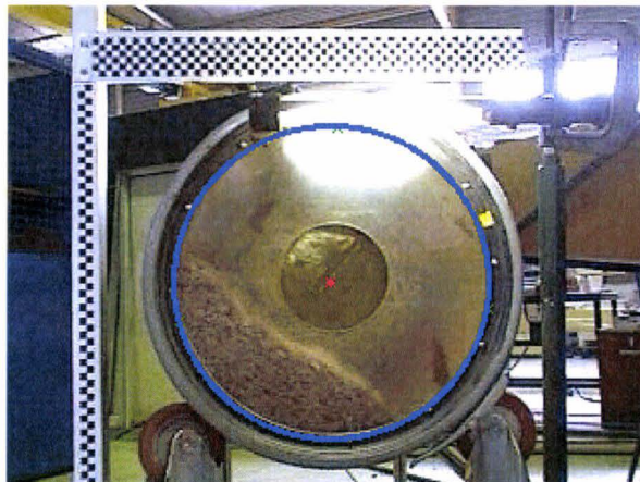
Figure 2-4 : Photo de mesure de l'angle dynamique de repos (EMD)
