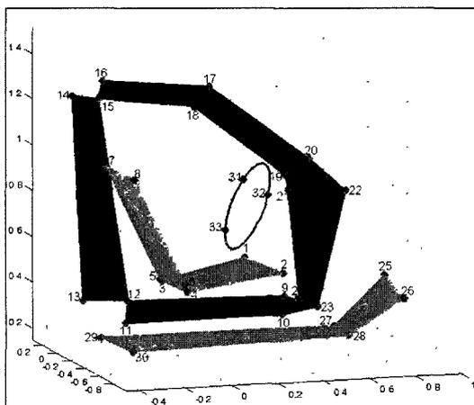
Figure 3 11. *Position des marqueurs sur chaque véhicule.*
