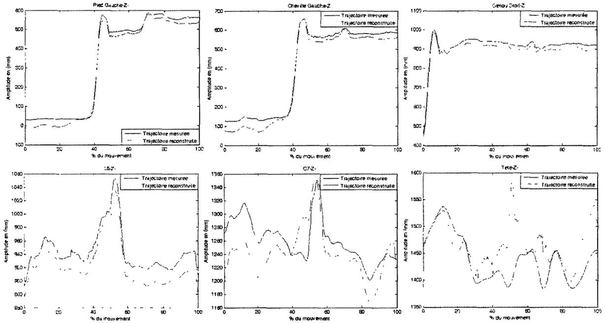
**Figure 3 15.** Trajectoires mesurées par le système optoélectronique et reconstruites à l'aide des angles calculés, des pieds, chevilles, genoux, L5, C7 et le vertex pour un sujet de sexe féminin, âgée de 72 ans, n'ayant pas de déficience motrice et adoptant la stratégie MM (Cf. Chapitre 4) lors de son mouvement d'entrée.
