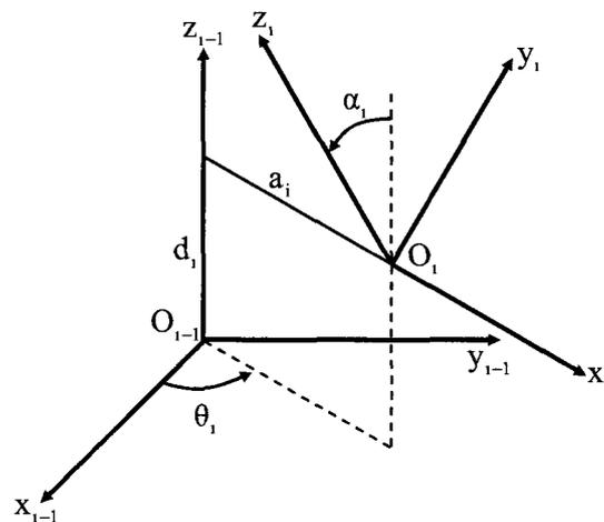
**Figure 2 4.** *Paramètres de Denavit et Hartenberg (1955).*
