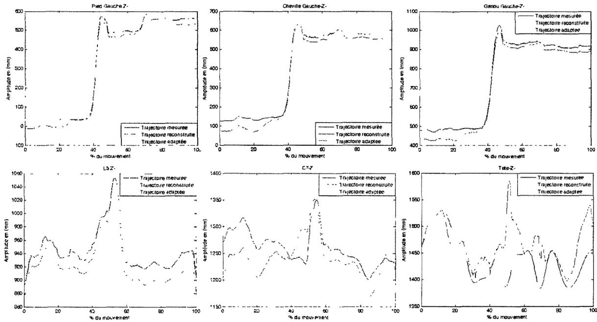
**Figure 3 16.** Trajectoires mesurées, reconstruites et adaptées par notre procédure, des pieds, chevilles, genoux, L5, C7 et le vertex pour un sujet de sexe féminin, âgée de 72 ans, n'ayant pas de déficience motrice et adoptant la stratégie MM (Cf. Chapitre 4) lors de son mouvement d'entrée.
