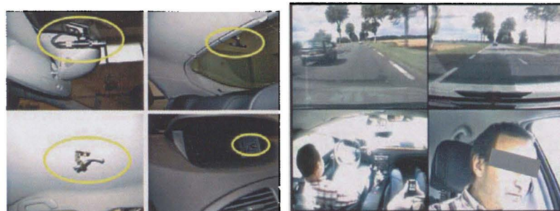
Figure 18 : Implantation des 4 caméras à l'intérieur de l'habitacle – Exemple de vue
