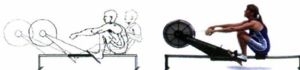
Figure AIII.4 : Schéma et photo d'un ergomètre sur rail (type Care ROWPERFECT®)
