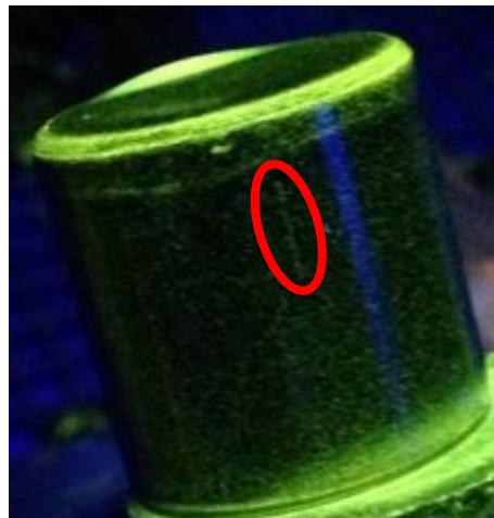
Figure V-3. Photographie prise suite à une magnétoscopie d'un défaut créé par ablation de matière à l'aide d'un laser de marquage.
