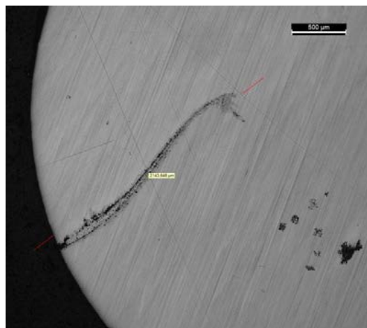
Figure III-4. Coupe circonférentielle d'un rouleau en acier de diamètre 6 mm et de hauteur 7,5mm présentant un repli de laminage caractérisé par une profondeur d'environ 2 mm.
