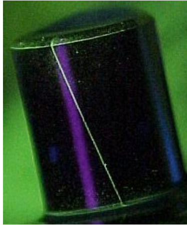
Figure V-4. Photographie prise suite à une magnétoscopie d'un défaut naturel de type repli de laminage.
