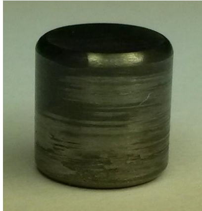
Figure III-6. Photographie d'une brûlure mis en évidence suite à une attaque Nital sur un rouleau en acier dont le diamètre et la hauteur valent 8 mm.
