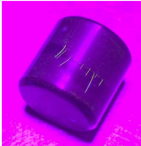
Figure III-5. Photographie de criques de rectification mis en évidence par la méthode de la magnétoscopie sur un rouleau en acier dont le diamètre et la hauteur valent 8 mm.
