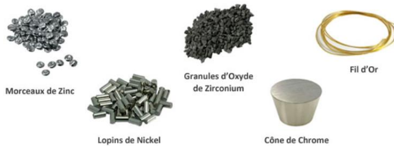
Figure 2.19 : Exemple de formes de matériaux d'évaporation, utilisés dans les bâtis sous vide.
