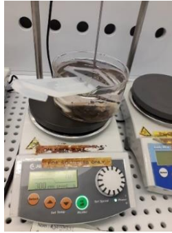
Figure 2.26 : Agitateur magnétique pour lift off.
