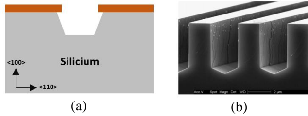
Figure 4.5 : (a) Schéma d'un profil de gravure anisotrope du silicium, (b) Image MEB d'une gravure humide à base de KOH de surfaces en Silicium orienté (110) [102].
