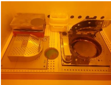
Figure 2.25 : Dispositif expérimental de dépôt par spin coating.
