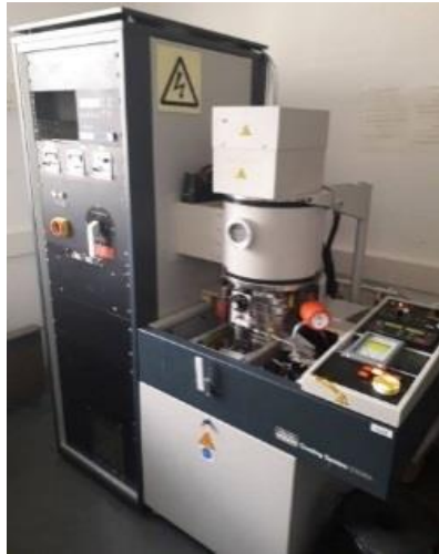
Figure 2.22 : Bati de dépôt par pulvérisation magnétron.
