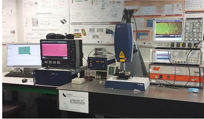
Figure 4.11 : Dispositif Polytec UHF-120.
