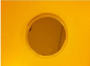
Figure 2.24 : Substrat de silicium métallisé.
