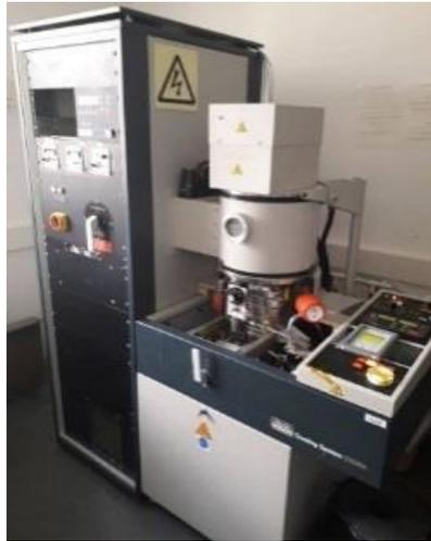
Figure 2.22 : Bati de dépôt par pulvérisation magnétron.
