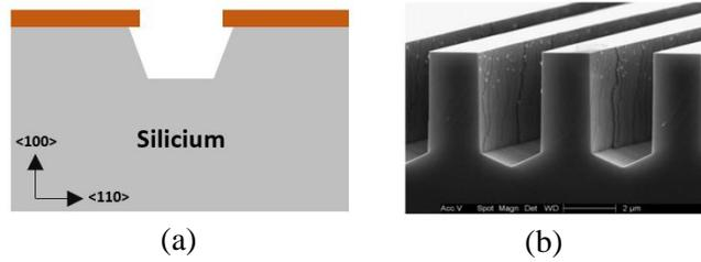
Figure 4.5 : (a) Schéma d'un profil de gravure anisotrope du silicium, (b) Image MEB d'une gravure humide à base de KOH de surfaces en Silicium orienté (110) [102].
