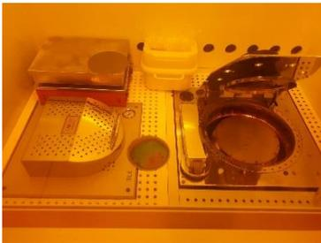
Figure 2.25 : Dispositif expérimental de dépôt par spin coating.
