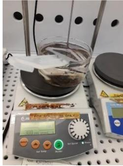
Figure 2.26 : Agitateur magnétique pour lift off.
