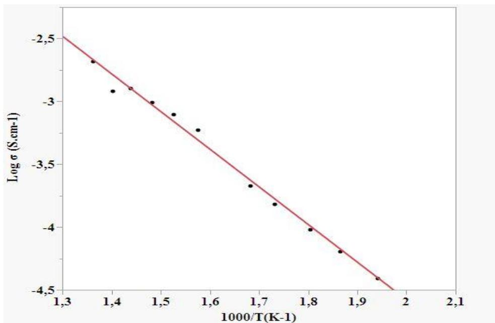
Figure V-19. : Evolution de la conductivité en fonction de la température pour  $\text{Ag}_2\text{Mg}_2\text{Fe}(\text{PO}_4)_3$
