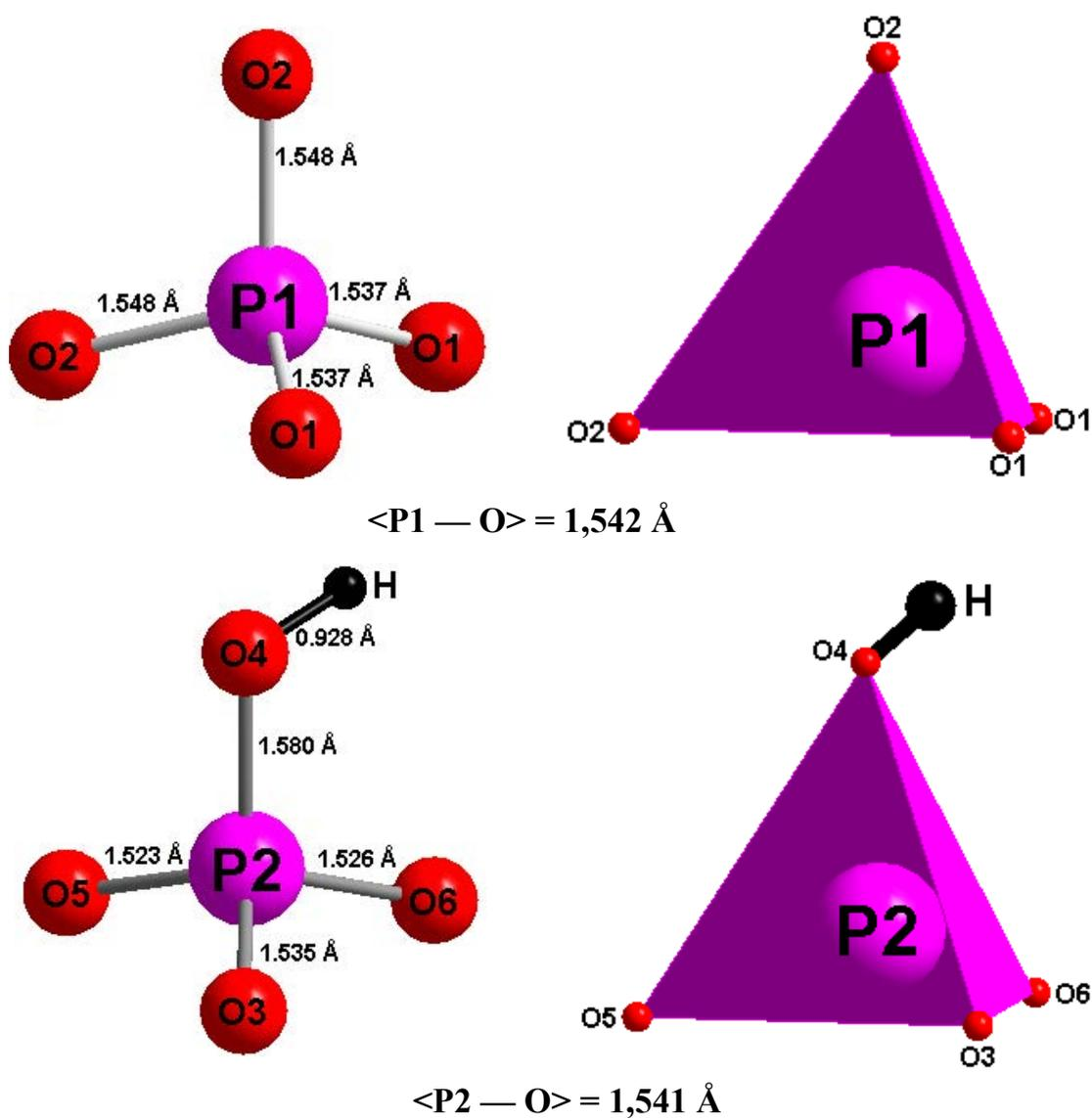
Figure IV-1 : Environnement des ions  $\text{P}^{5+}$  dans les sites P1 et P2 pour  $\text{NaMg}_3(\text{HPO}_4)_2(\text{PO}_4)$
