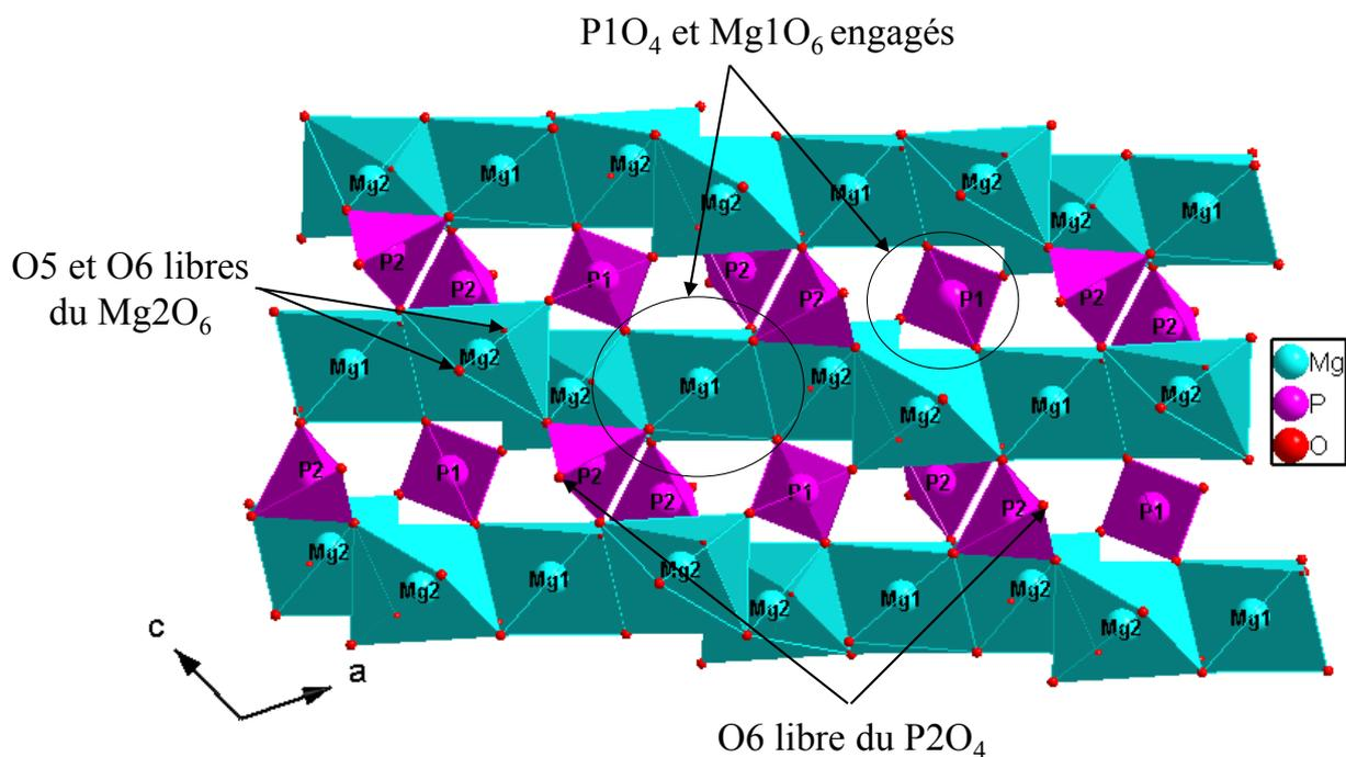
Figure IV-6 : Feuille parallèle au plan  $(\vec{a}, \vec{c})$  pour  $\text{NaMg}_3(\text{HPO}_4)_2(\text{PO}_4)$
