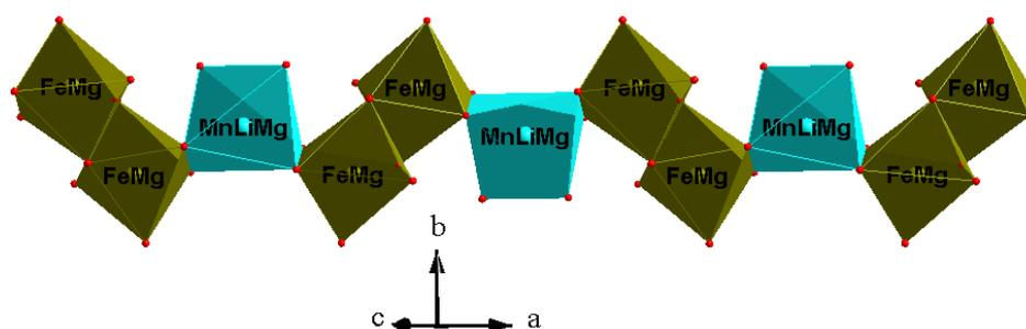
Figure I-11 : Chaîne en zigzag suivant la rangée [101]
