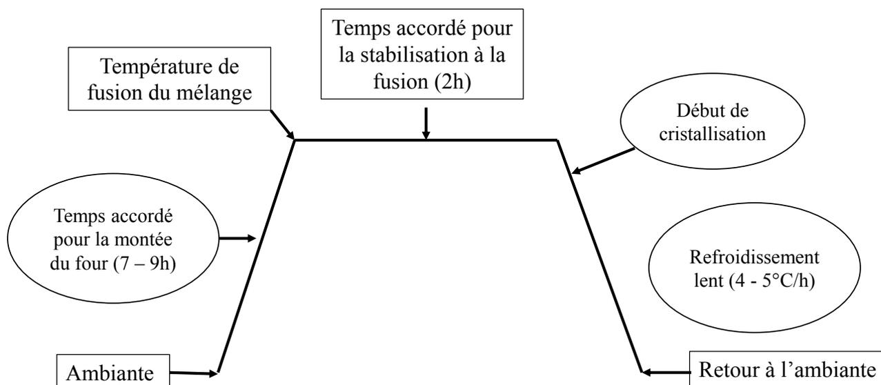
Figure 3 : Programme du traitement thermique nécessaire à la croissance cristalline
