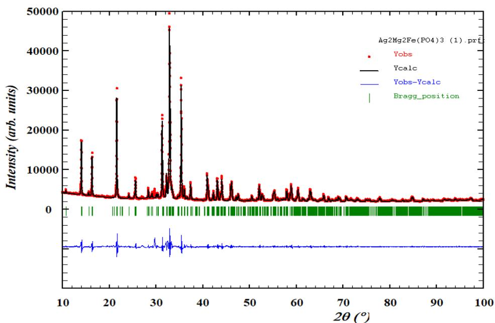
Figure V-13 : Diagrammes de diffraction de rayons X calculé, observé et différence pour  $\text{Ag}_2\text{Mg}_2\text{Fe}(\text{PO}_4)_3$
