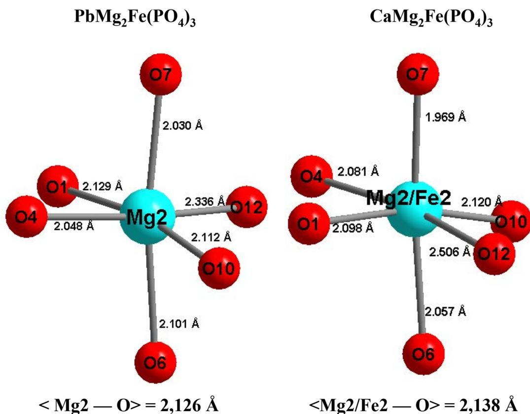
Figure III-14 : Environnement de l'ion Mg<sup>2+</sup> dans les sites Mg<sub>2</sub> et Mg<sub>2</sub>/Fe<sub>2</sub> pour les composés MMg<sub>2</sub>Fe(PO<sub>4</sub>)<sub>3</sub> (M = Ca, Pb)
