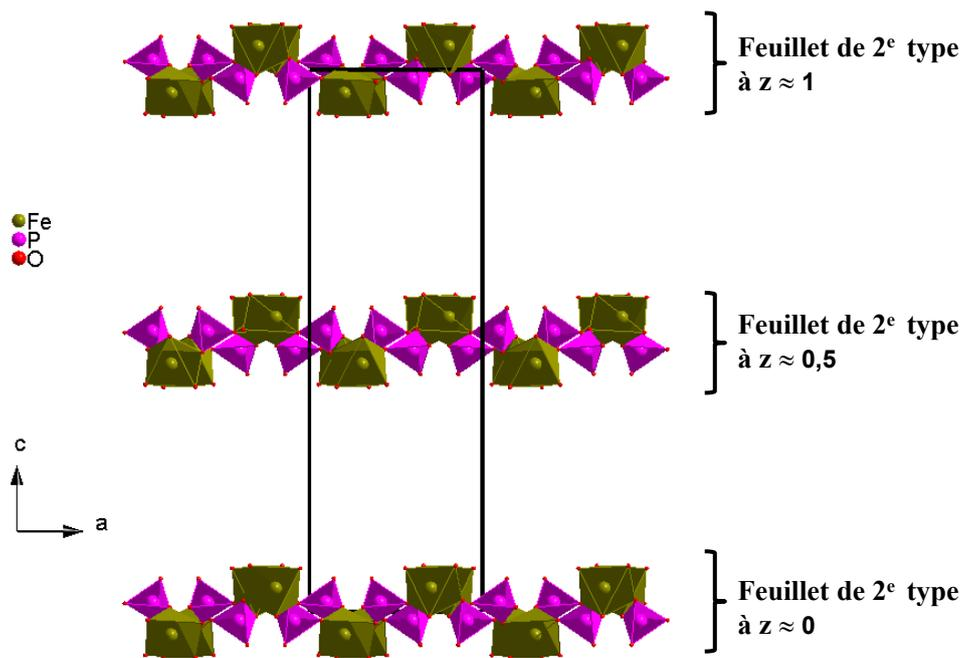
Figure III-35 : Projection des feuillets de 2<sup>ème</sup> type dans le plan  $(\vec{a}, \vec{c})$  pour  $\text{Ca}_2\text{MgFe}_2(\text{PO}_4)_4$
