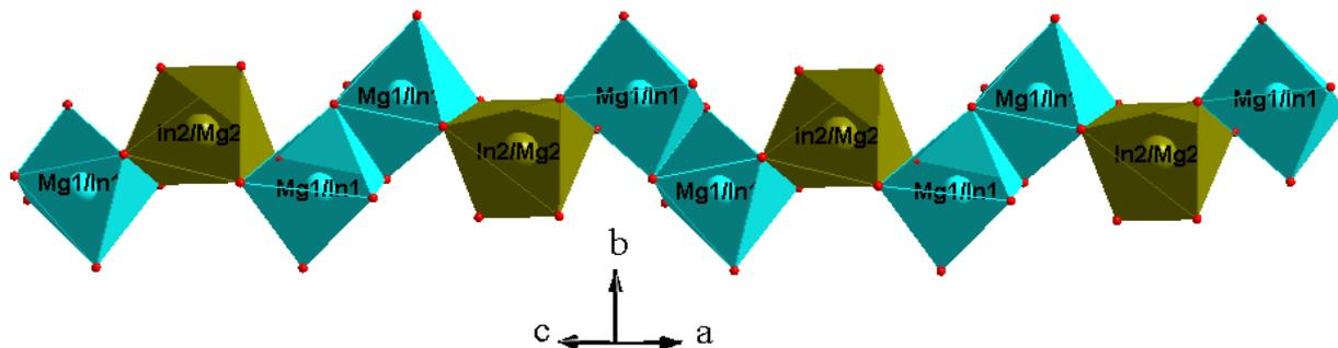
Figure V-23 : Chaînes infinie suivant  $[101]$  pour  $\text{Na}_{1,85}\text{Mg}_{1,85}\text{In}_{1,15}(\text{PO}_4)_3$  et  $\text{Ag}_{1,69}\text{Mg}_{1,69}\text{In}_{1,31}(\text{PO}_4)_3$
