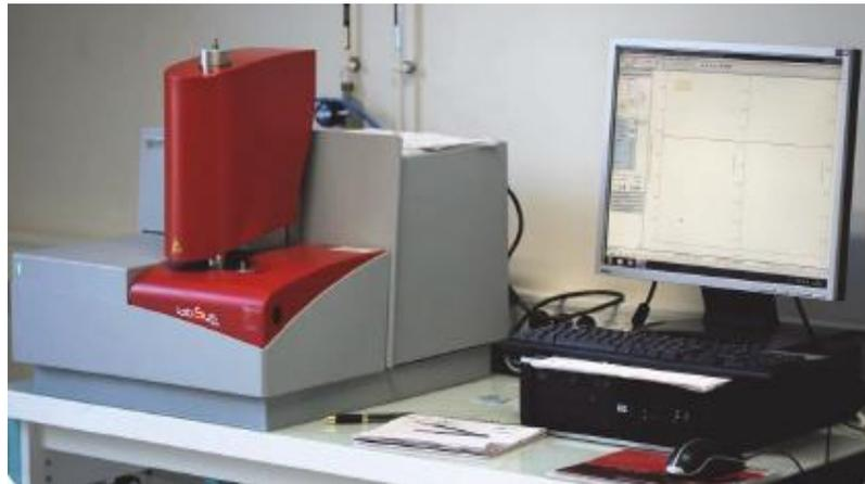
Figure 6 : Appareil d'Analyse thermogravimétrique et différentielle (ATG/ATD/DSC) SETARAM LabSysEvo
