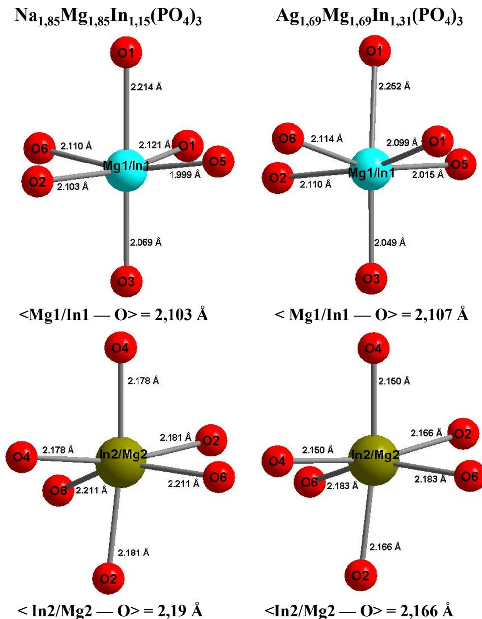
Figure V-21 : Environnement des ions  $\text{Mg}^{2+}$  et  $\text{In}^{3+}$  dans les sites Mg1/In1 et In2/Mg2 dans  $\text{Na}_{1,85}\text{Mg}_{1,85}\text{In}_{1,15}(\text{PO}_4)_3$  et  $\text{Ag}_{1,69}\text{Mg}_{1,69}\text{In}_{1,31}(\text{PO}_4)_3$
