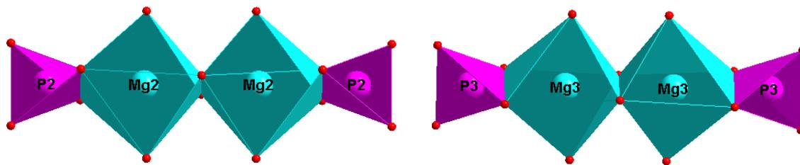
Figure II-4 : Représentation des entités  $Mg_2P_2O_{14}$  et  $Mg_3P_3O_{14}$  pour  $PbMg_3(HPO_4)(PO_4)_2$
