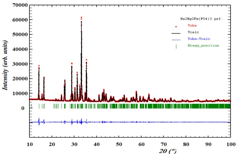
Figure V-12 : Diagrammes de diffraction de rayons X calculé, observé et différence pour  $\text{Na}_2\text{Mg}_2\text{Fe}(\text{PO}_4)_3$
