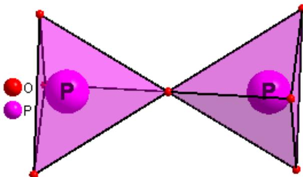
Figure I-3 : Diphosphate  $P_2O_7^{4-}$  du phosphate  $Ca_2P_2O_7 \cdot H_2O$  [31]
