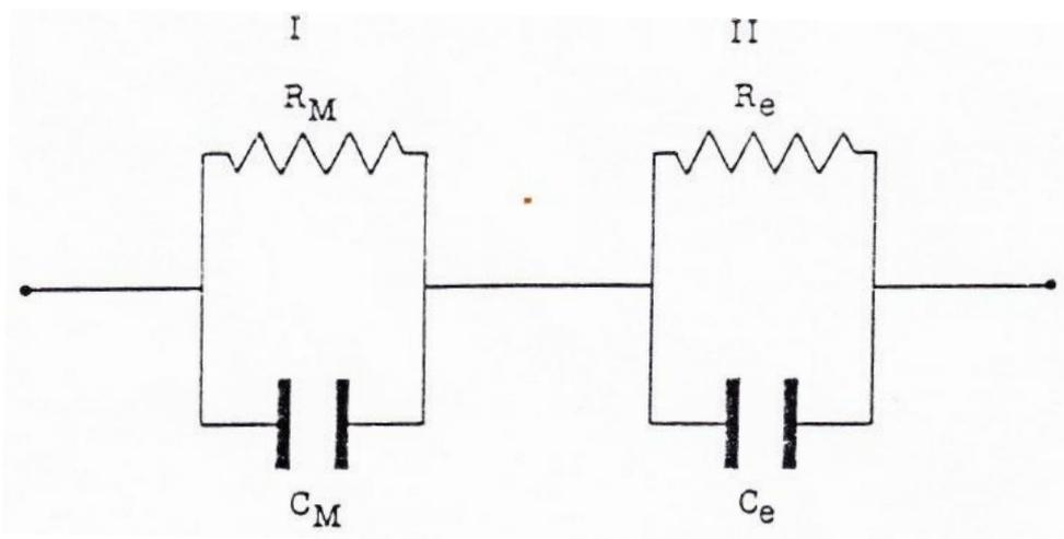
Figure 7 : Schématisation de l'échantillon (M), des réactions à l'interface électrode – électrolyte (e)
