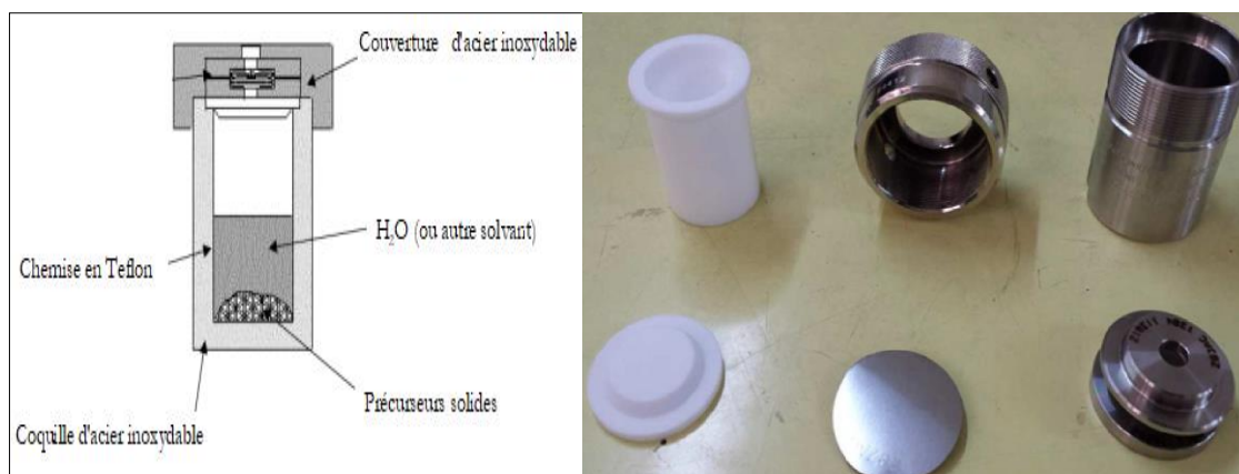
Figure 1 : Schéma et l'équipement d'un autoclave utilisé pour les synthèses hydrothermales
