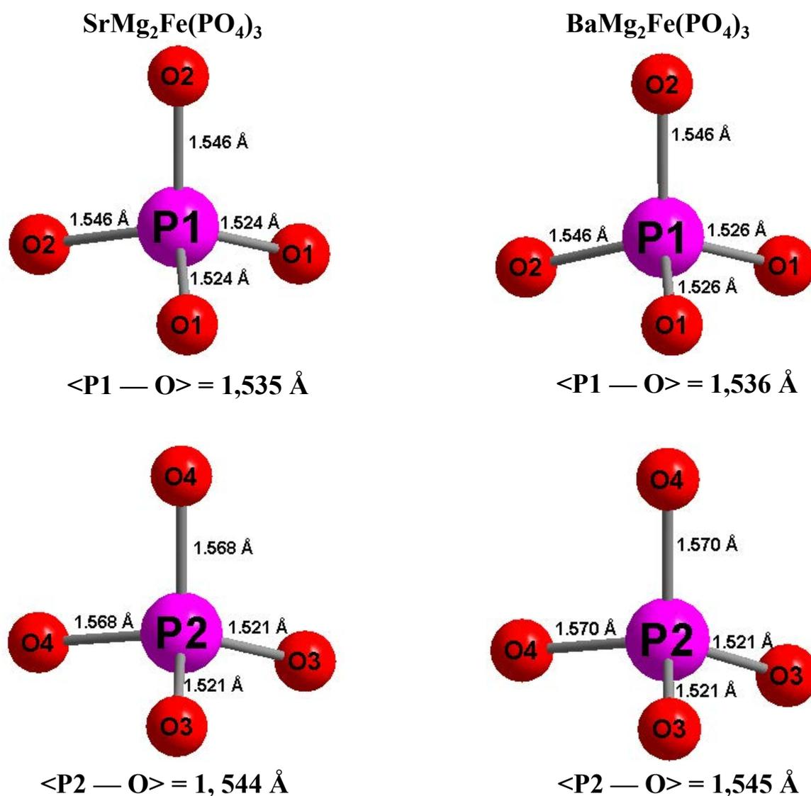
Figure III-1 : Environnement des ions P<sup>5+</sup> dans les sites P1 et P2 dans les composés MMg<sub>2</sub>Fe(PO<sub>4</sub>)<sub>3</sub> (M = Sr, Ba)
