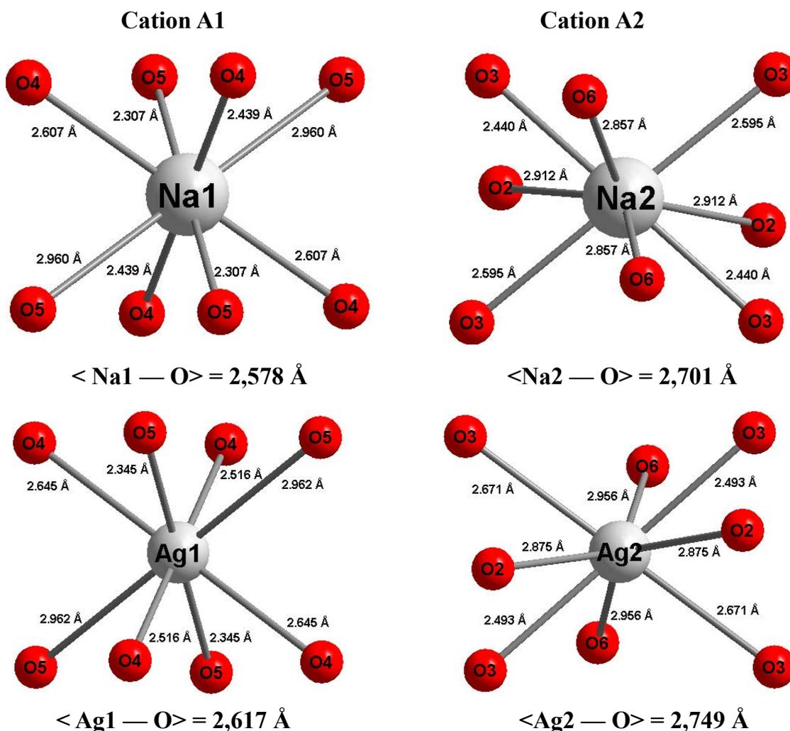
Figure V-22 : Environnement des ions  $\text{Na}^+$  dans les sites Na1 et Na2 et des ions  $\text{Ag}^+$  dans les sites Ag1 et Ag2 dans  $\text{Na}_{1,85}\text{Mg}_{1,85}\text{In}_{1,15}(\text{PO}_4)_3$  et  $\text{Ag}_{1,69}\text{Mg}_{1,69}\text{In}_{1,31}(\text{PO}_4)_3$
