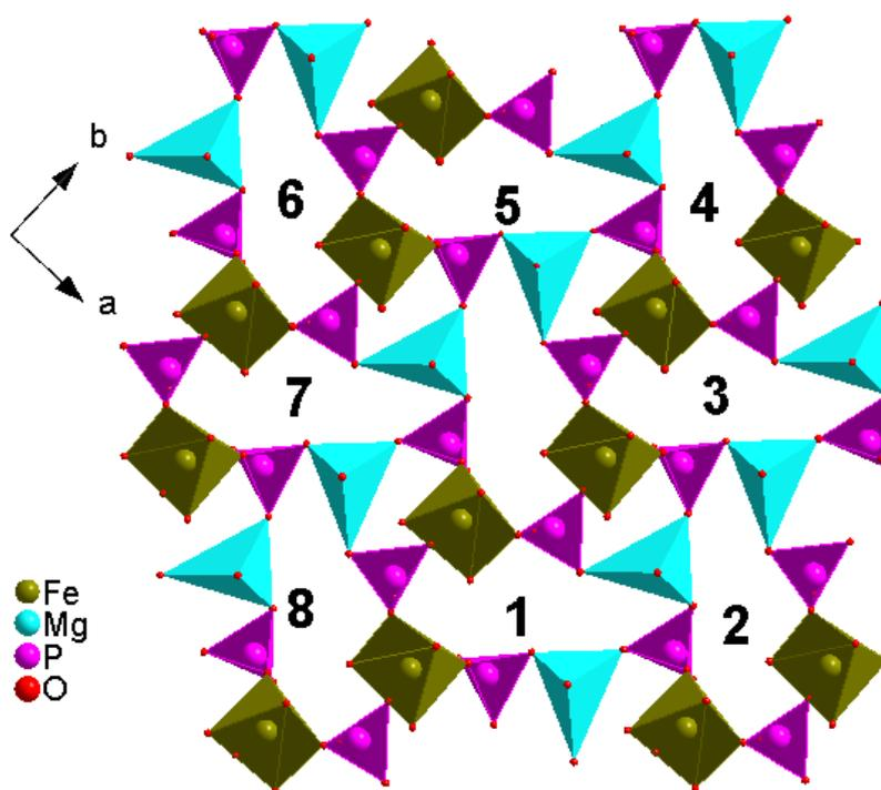
Figure III-30 : Premier type de feuillet dans le plan  $(\vec{a}, \vec{b})$  pour  $\text{Ca}_2\text{MgFe}_2(\text{PO}_4)_4$
