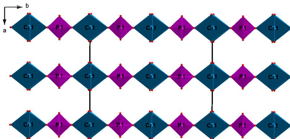
Figure I-7 : Chaînes infinies Cr1P1O<sub>9</sub> orientées suivant l'axe  $\vec{b}$
