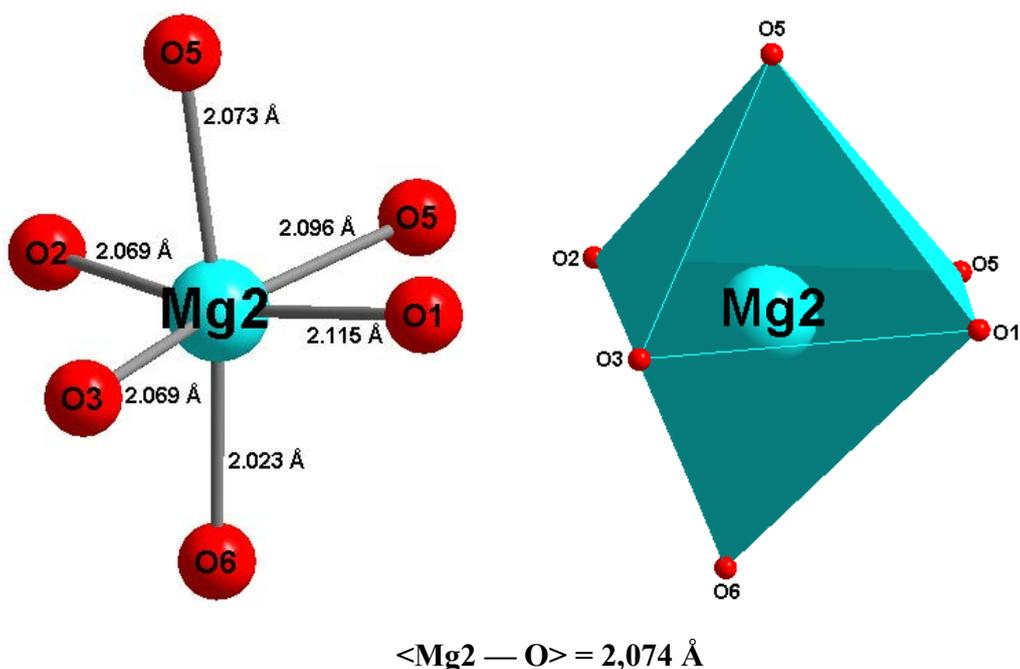
Figure IV-2 : Environnement des ions  $Mg^{2+}$  dans les sites Mg1 et Mg2 pour  $NaMg_3(HPO_4)_2(PO_4)$
