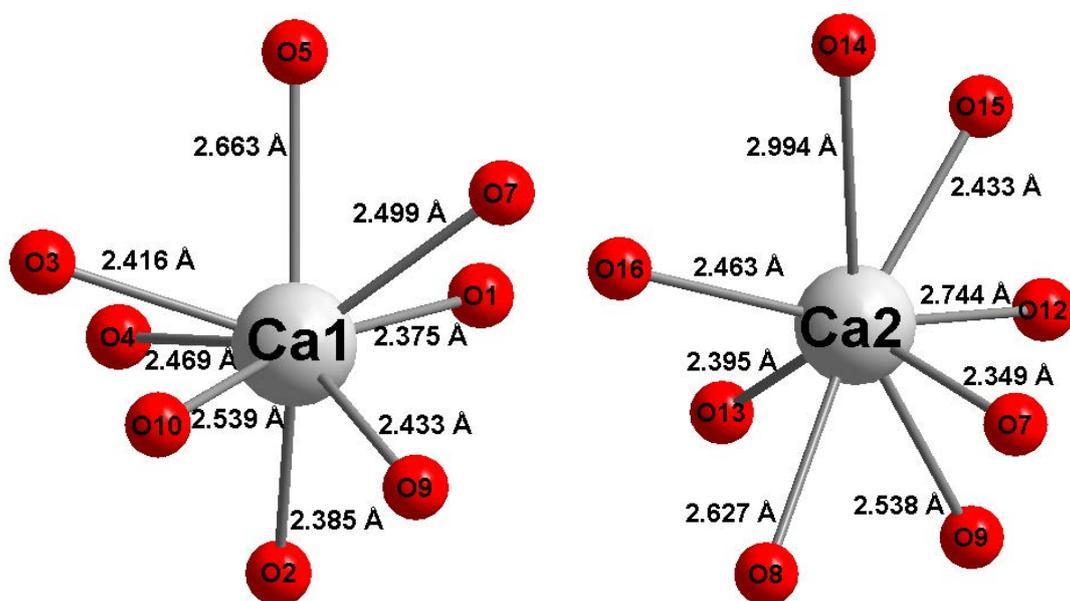
Figure III-28 : Environnement des ions  $\text{Ca}^{2+}$  dans les sites Ca1 et Ca2 pour  $\text{Ca}_2\text{MgFe}_2(\text{PO}_4)_4$
