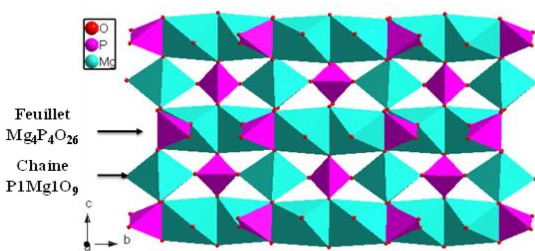
Figure II-7 : Représentation de la jonction entre les chaînes  $Mg_1P_1O_9$  et les feuillets  $Mg_4P_4O_{26}$  pour  $PbMg_3(HPO_4)(PO_4)_2$
