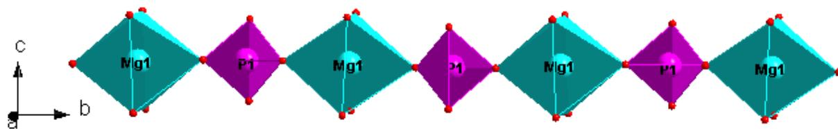
Figure II-6 : Représentation de la chaîne  $Mg_1P_1O_9$  suivant l'axe  $\vec{b}$  pour  $PbMg_3(HPO_4)(PO_4)_2$
