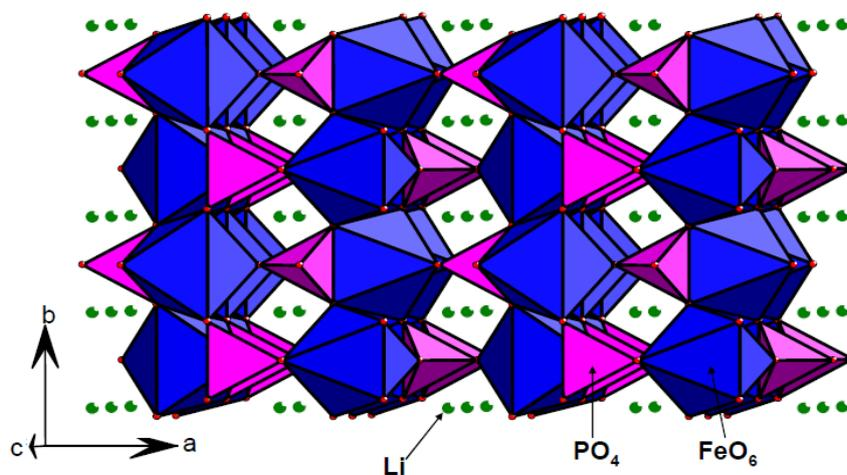
Figure I-6 : Représentation de la structure  $\text{LiFePO}_4$  dans le plan  $(\vec{a}, \vec{b})$  [50]
