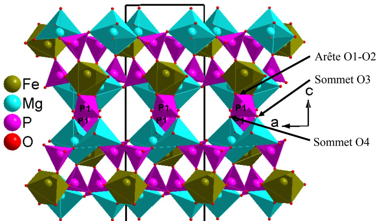
Figure III-23 : Connexion entre doubles feuillets dans le plan  $(\vec{a}, \vec{c})$  pour  $MMg_2Fe(PO_4)_3$  ( $M = Ca, Pb$ )
