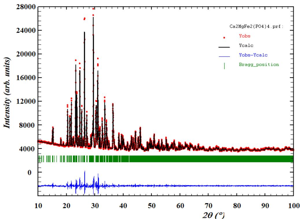
Figure III-37 : Diffractogrammes calculé, observé et différence pour  $\text{Ca}_2\text{MgFe}_2(\text{PO}_4)_4$
