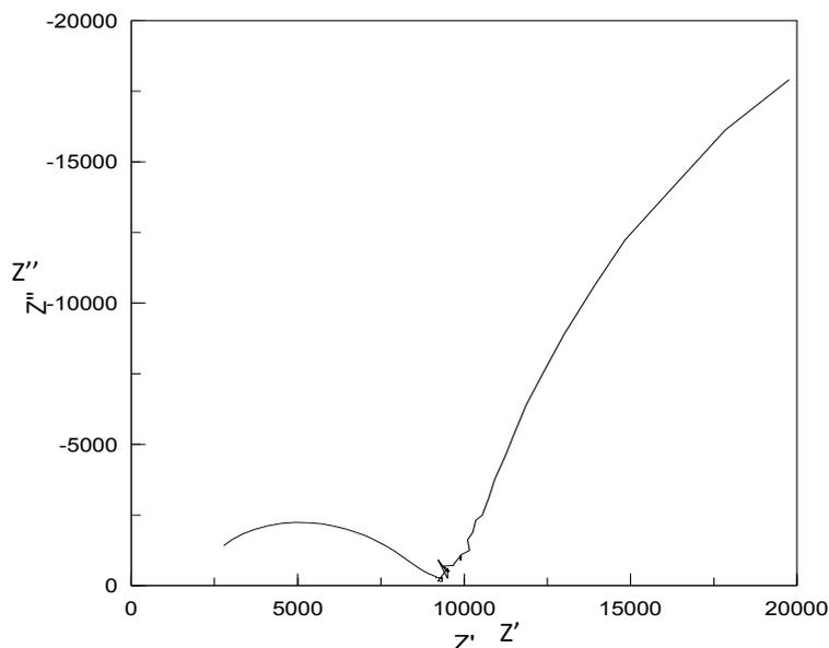
Figure V-18 : Impédance complexe de  $\text{Na}_2\text{Mg}_2\text{Fe}(\text{PO}_4)_3$  à  $500^\circ\text{C}$
