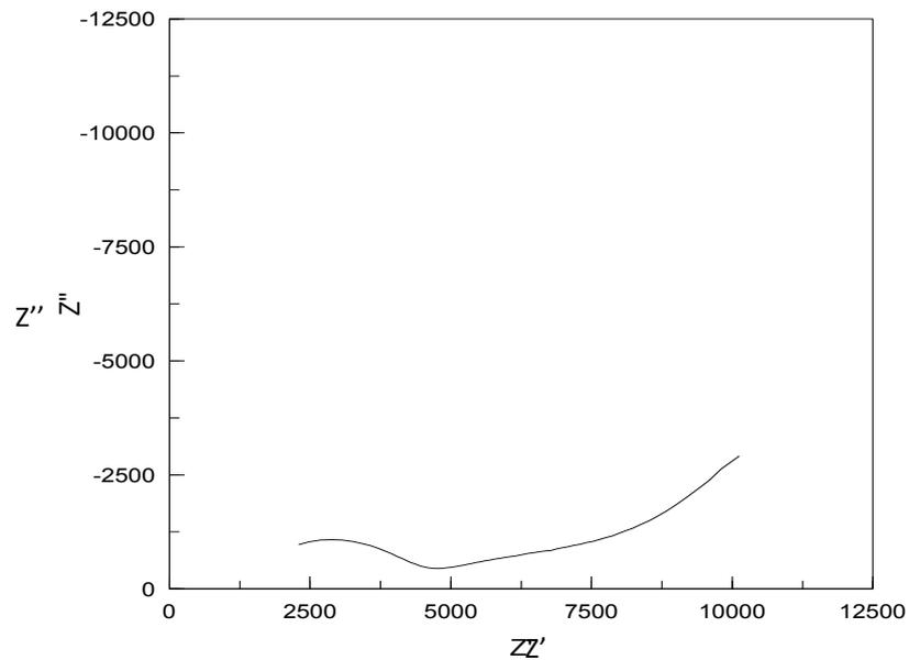
Figure V-17 : Impédance complexe de  $\text{Ag}_2\text{Mg}_2\text{Fe}(\text{PO}_4)_3$  à  $300^\circ\text{C}$
