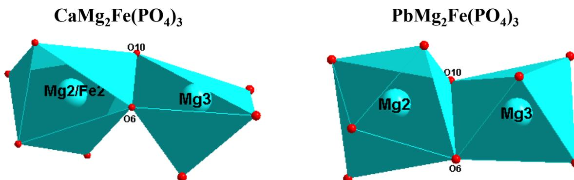
Figure III-16 : Entités Mg<sub>2</sub>Mg<sub>3</sub>O<sub>9</sub> et (Mg<sub>2</sub>/Fe<sub>2</sub>)Mg<sub>3</sub>O<sub>9</sub> pour MMg<sub>2</sub>Fe(PO<sub>4</sub>)<sub>3</sub> (M = Ca, Pb) pour MMg<sub>2</sub>Fe(PO<sub>4</sub>)<sub>3</sub> (M = Ca, Pb)
