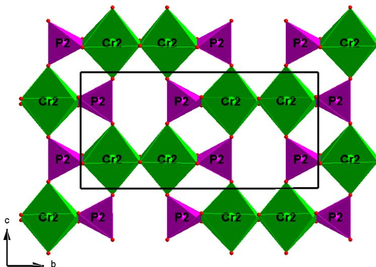
Figure I-9 : Feuillet  $\text{Cr}_4\text{P}_4\text{O}_{24}$  dans le plan  $(\vec{b}, \vec{c})$
