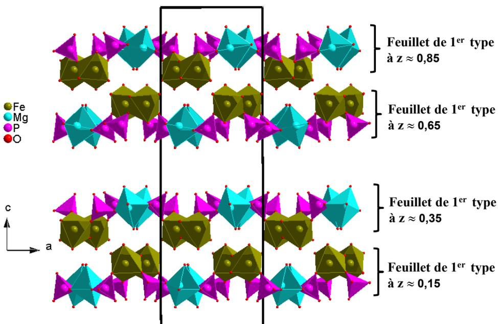
Figure III-33 : Projection des feuillets de 1<sup>er</sup> type dans le plan  $(\vec{a}, \vec{c})$  pour  $\text{Ca}_2\text{MgFe}_2(\text{PO}_4)_4$
