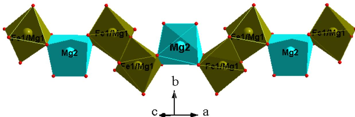
Figure V-7 : Chaîne infinie  $[(\text{Fe1/Mg1})_2\text{Mg}_2\text{O}_{14}]_\infty$  suivant la rangée [101] pour  $\text{Na}_2\text{Mg}_2\text{Fe}(\text{PO}_4)_3$  et  $\text{Ag}_{1,67}\text{Mg}_{2,33}\text{Fe}_{0,89}(\text{PO}_4)_3$
