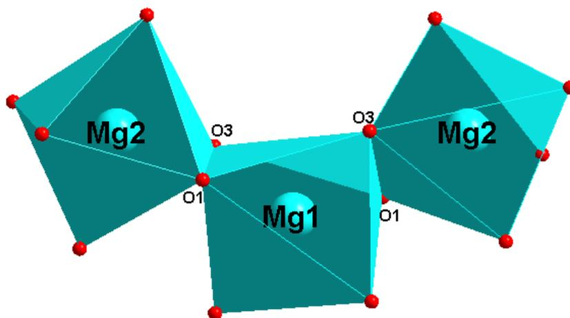
Figure IV-4 : Trimère  $Mg(2)_2Mg(1)O_{14}$  pour  $NaMg_3(HPO_4)_2(PO_4)$
