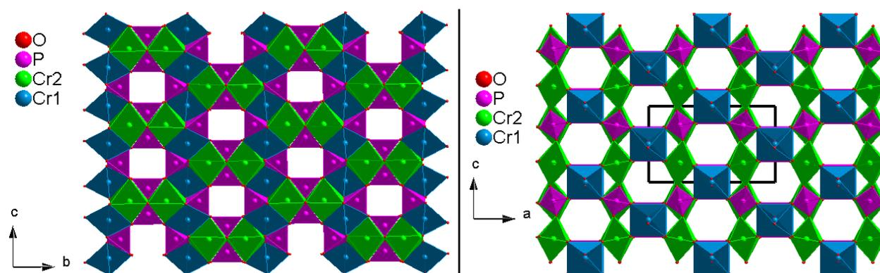
Figure I-10 : Projection de la structure de type  $\alpha$ -CrPO<sub>4</sub> dans le plan  $(\vec{b}, \vec{c})$  et  $(\vec{a}, \vec{c})$
