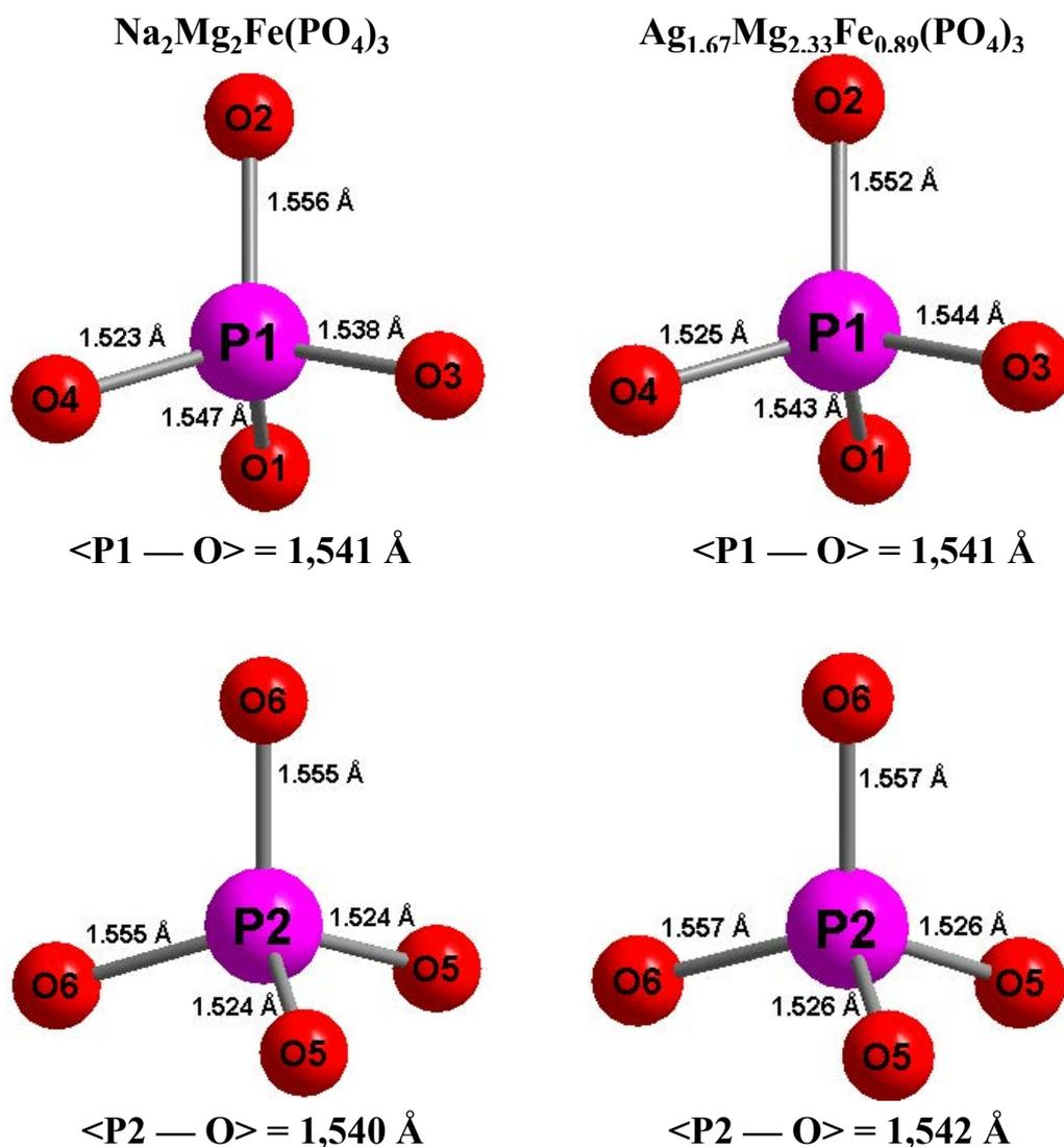
Figure V-1 : Environnement des ions  $P^{5+}$  dans les sites P1 et P2 pour  $Na_2Mg_2Fe(PO_4)_3$  et  $Ag_{1,67}Mg_{2,33}Fe_{0,89}(PO_4)_3$
