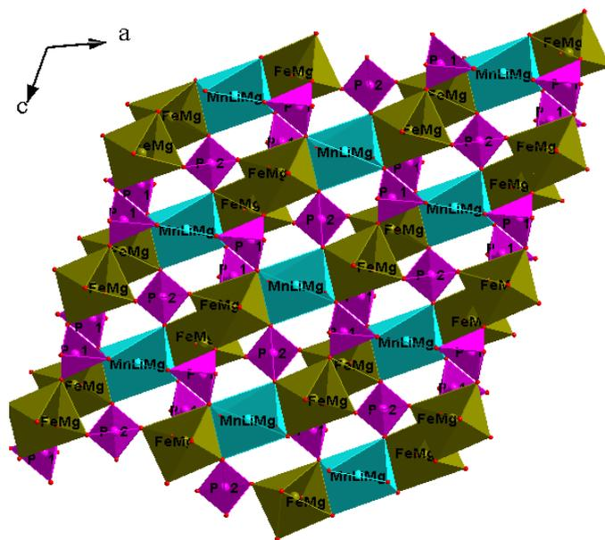
Figure I-12 : Feuillet parallèle au plan  $(\vec{a}, \vec{c})$
