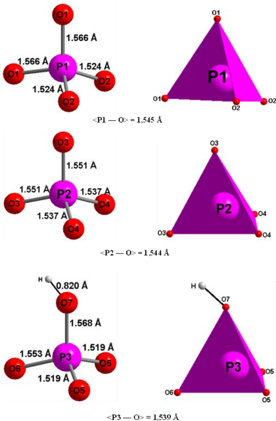
Figure II-1 : Environnement des ions P<sup>5+</sup> dans les sites P1, P2 et P3 pour PbMg<sub>3</sub>(HPO<sub>4</sub>)(PO<sub>4</sub>)<sub>2</sub>
