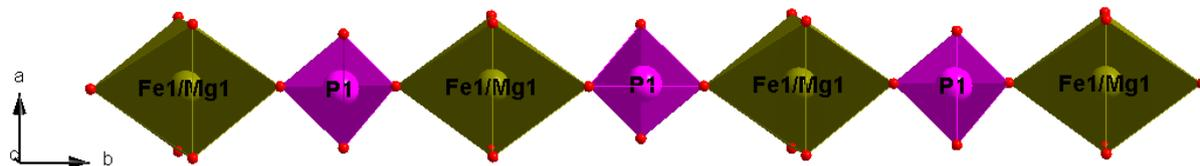
Figure III-8 : Chaîne infinie  $(\text{Fe1/Mg1})\text{P1O}_9$  suivant l'axe  $\vec{b}$  pour les composés  $\text{MMg}_2\text{Fe}(\text{PO}_4)_3$  ( $\text{M} = \text{Sr}, \text{Ba}$ )
