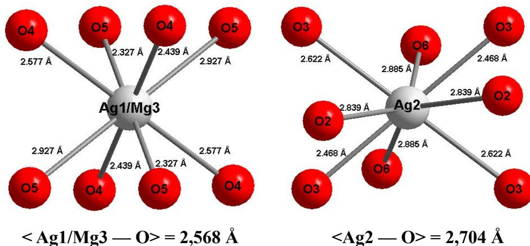
Figure V-5 : Environnement des ions  $\text{Ag}^+$  et  $\text{Mg}^{2+}$  dans le site Ag1/Mg3 et des ions  $\text{Ag}^+$  dans le site Ag2 pour  $\text{Ag}_{1,67}\text{Mg}_{2,33}\text{Fe}_{0,89}(\text{PO}_4)_3$
