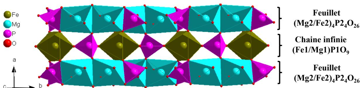
Figure III-9 : Représentation de la jonction entre les chaînes  $(\text{Fe1/Mg1})\text{P1O}_9$  et les feuillets  $(\text{Mg2/Fe2})_4\text{P}_2\text{O}_{26}$  pour les composés  $\text{MMg}_2\text{Fe}(\text{PO}_4)_3$  ( $\text{M} = \text{Sr}, \text{Ba}$ )
