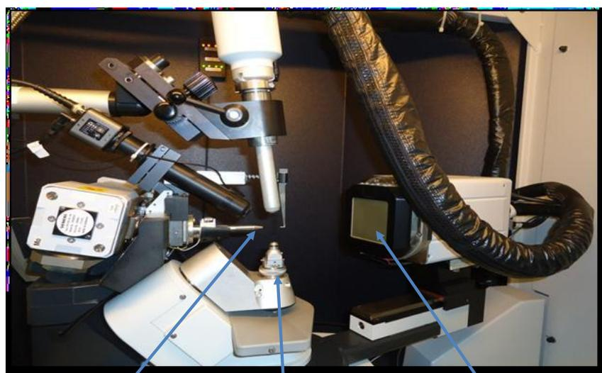
Faisceau des rayons X    Tête goniométrique    Caméra CCD
