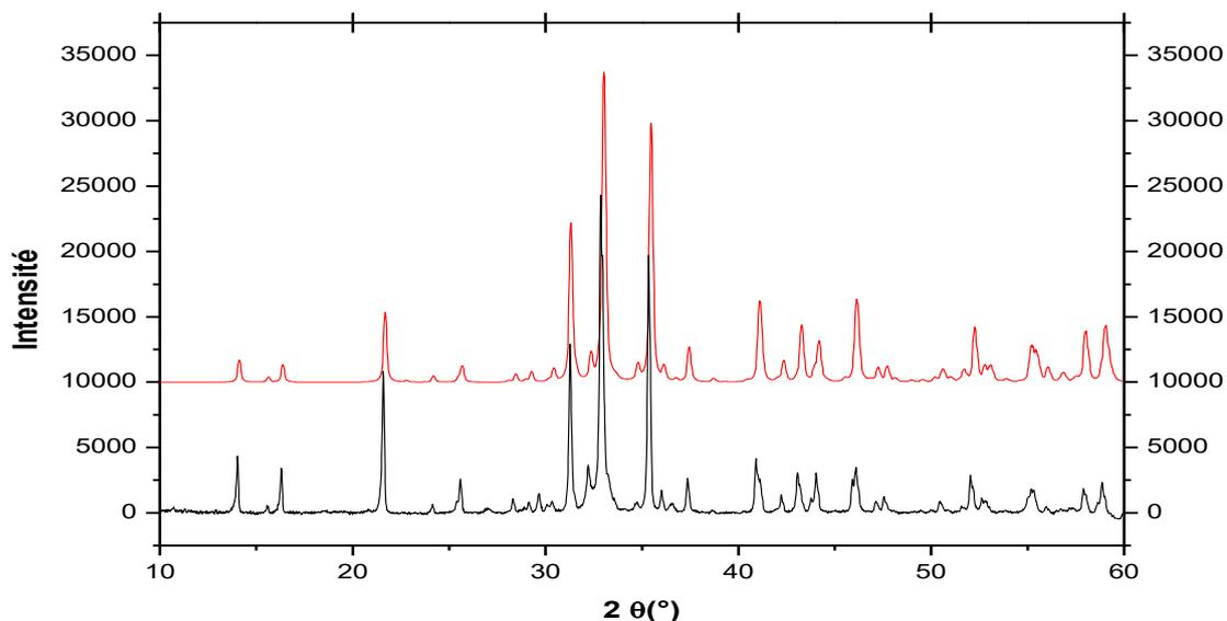
Figure V-11 : Diagramme de diffraction X expérimental (noir) et calculé à partir des données sur monocristal (rouge) de  $\text{Ag}_2\text{Mg}_2\text{Fe}(\text{PO}_4)_3$
