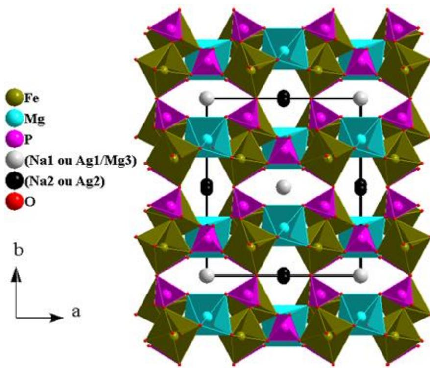
Figure V-9 : Projection de la structure des phosphates  $\text{Na}_2\text{Mg}_2\text{Fe}(\text{PO}_4)_3$  et  $\text{Ag}_{1,67}\text{Mg}_{2,33}\text{Fe}_{0,89}(\text{PO}_4)_3$  dans le plan  $(\vec{a}, \vec{b})$
