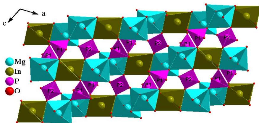
Figure V-24 : Feuillet parallèle au plan  $(\vec{a}, \vec{c})$  pour  $\text{Na}_{1,85}\text{Mg}_{1,85}\text{In}_{1,15}(\text{PO}_4)_3$  et  $\text{Ag}_{1,69}\text{Mg}_{1,69}\text{In}_{1,31}(\text{PO}_4)_3$
