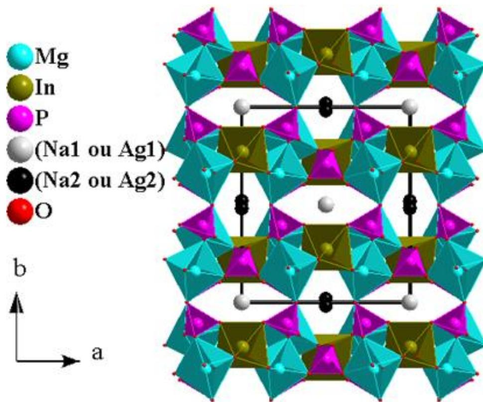
Figure V-25 : Projection de la structure de  $\text{Na}_{1,85}\text{Mg}_{1,85}\text{In}_{1,15}(\text{PO}_4)_3$  et de  $\text{Ag}_{1,69}\text{Mg}_{1,69}\text{In}_{1,31}(\text{PO}_4)_3$  dans le plan  $(\vec{a}, \vec{b})$
