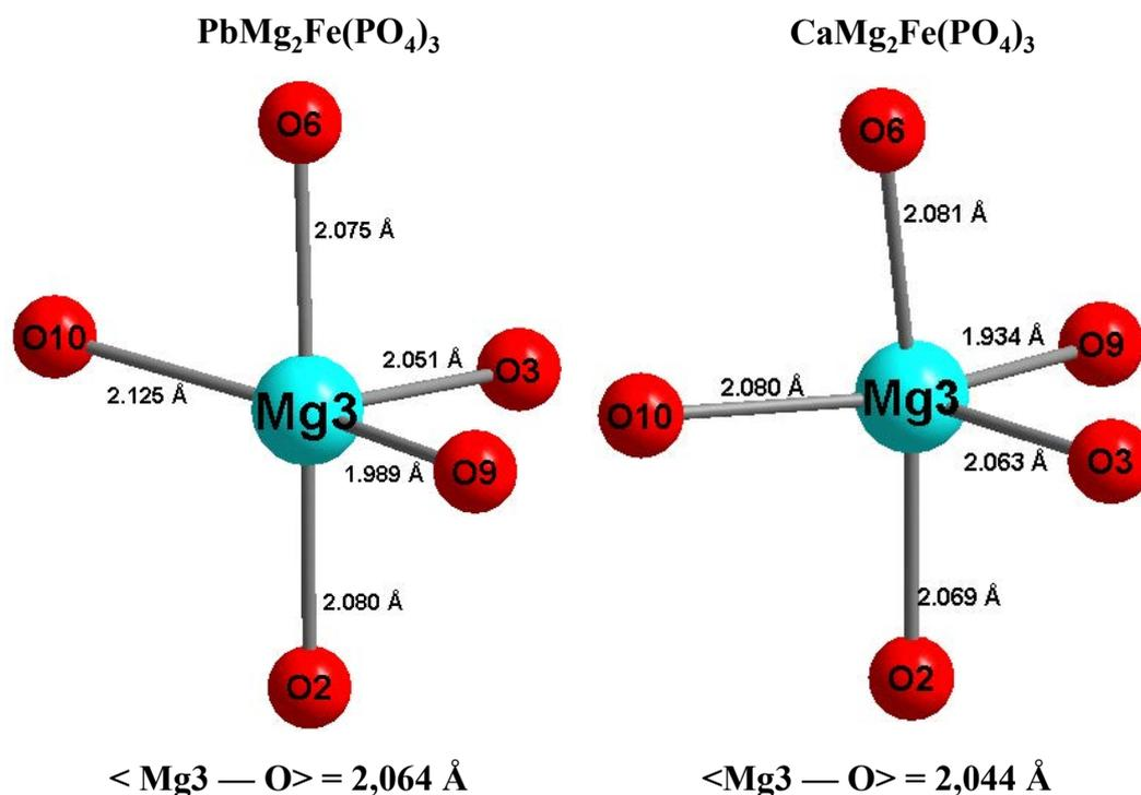
Figure III-15 : Environnement des ions Mg<sup>2+</sup> dans le site Mg3 pour les composés MMg<sub>2</sub>Fe(PO<sub>4</sub>)<sub>3</sub> (M = Ca, Pb)
