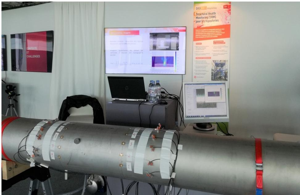
**FIGURE 4.31** – Démonstrateur du système de contrôle santé passif des tuyaux qui a été présenté à différents acteurs industriels et de partenaires académiques du CEA.
