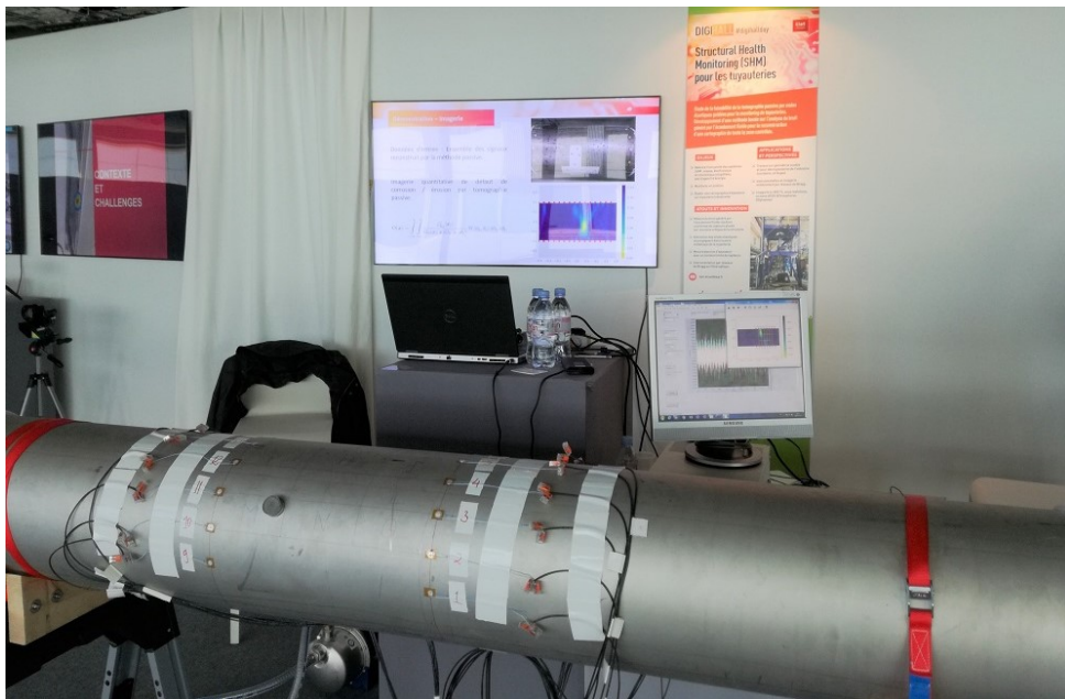
FIGURE 4.31 – Démonstrateur du système de contrôle santé passif des tuyaux qui a été présenté à différents acteurs industriels et de partenaires académiques du CEA.
