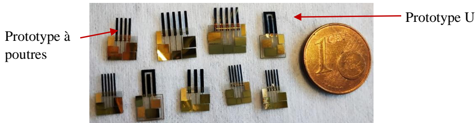
Figure 92: Photo des prototypes de MCM après intégration complète, incluant les contacts électriques en or. Chaque poutre d'un prototype peut être actionnée individuellement.
