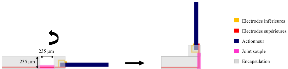
Figure 95: Schéma vue de profil du pliage d'un doigt. L'espace entre le doigt et la paume est égale à l'épaisseur de la paume pour permettre de bloquer le doigt lors de son pliage.
