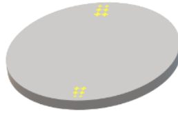
Figure 73: Etape 2: les croix d'alignement en face arrière de la plaquette de silicium.
