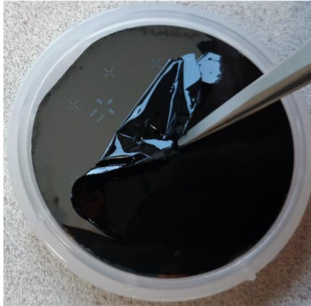
Figure 160: Pelage de l'actionneur fabriqué sur les motifs des connecteurs en SU-8 des micromanipulateurs, dont l'épaisseur a été diminuée par un plasma d'oxygène pur.
