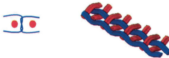
Figure 2. 22: Illustration du liage dans un tissu 2D toile [26]
