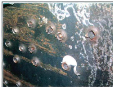
Figure 1. 8: Illustration de la déformation en forme de pétale de fleur [8]
