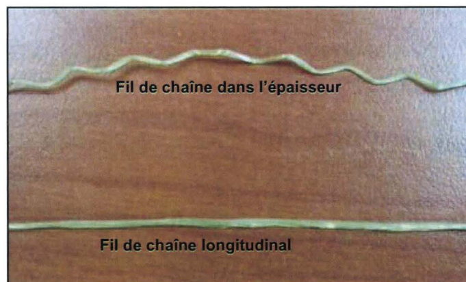
Figure 2. 30: Illustration de l'influence du tissage d'une structure orthogonal sur la consommation des fils de chaîne et de l'embuvage résultant
