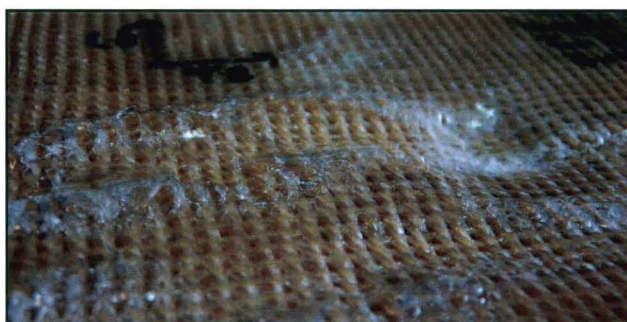
Figure 3. 15: Illustration du problème de pression lors de la réticulation de la résine après l'infusion, cas du « LtoL » Vectran® 40 fils/cm 38 duites/cm, face avant
