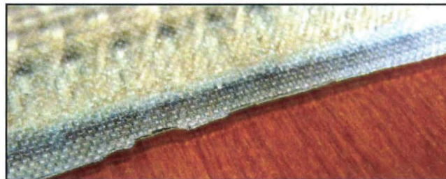
Figure 3. 12: Dépôt de résine sur les côtés de la structure, illustration avec le « LtoL » Vectran® 40 fils/cm 38 duites/cm
