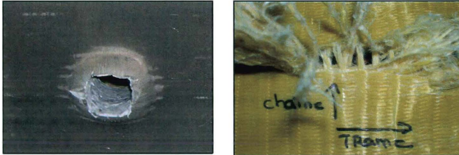
Figure 3. 8: Illustration de l'endommagement suivant le cas 3, avec l'exemple du « LtoL » 20 fils/cm 130 duites/cm avec une V_e = 700 m/s
