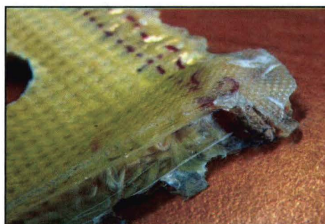
Figure 3. 13: Illustration du problème de stabilité durant la mise sous vide, cas du « TtT » Kevlar® 40 fils/cm 40 duites/cm
