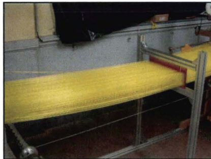
Figure 2. 27: Illustration du système de rail et des planches « d'empoutage »
