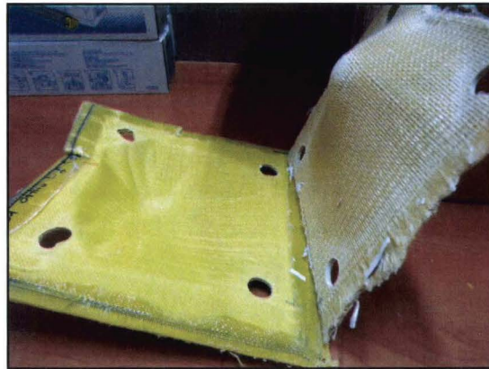
Figure 4. 5: Désolidarisation des deux tissus hybridés pendant l'impact, observation de la déformée du matériau Interlock, cas de l'hybride A1
