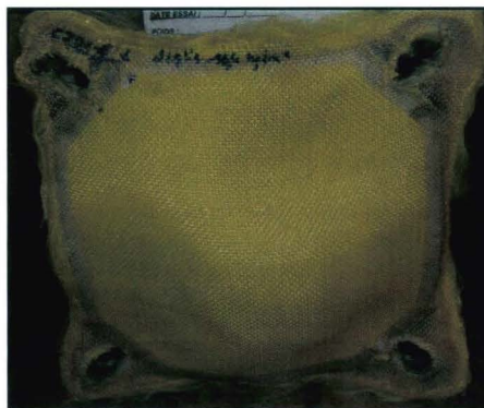
Figure 3. 9: Illustration de l'endommagement suivant le cas 4, avec l'exemple du préimprégné 7 fils/cm 7 duites/cm avec une V_e = 1000 m/s
