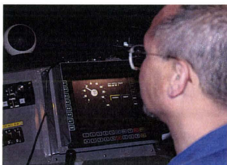
Figure 4.3 – Vue d'un DMI à bord d'un convoi
