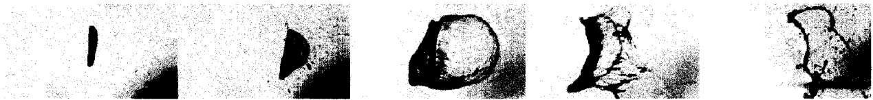
Figure 2.17 : Désintégration d'une gouttelette dans le mode « Bag break-up » [31]
