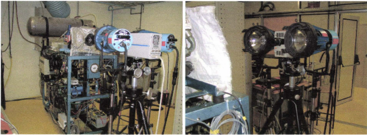
Figure 3.22 : La caméra et les deux projecteurs dans une configuration d'essai
