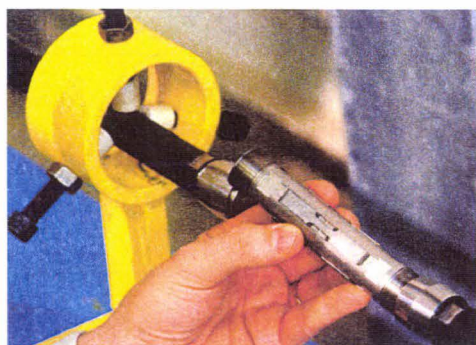
Figure A-8-2 : Montage de traction d'éprouvettes plates collées sur le dispositif aux barres de Hopkinson.
