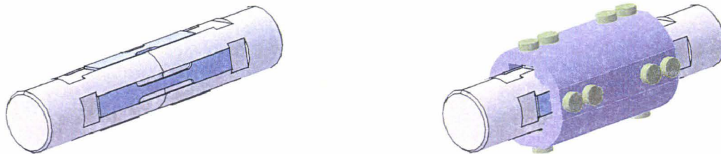
Figure 4-31 : Mise en place du second manchon pour centrage avant le collage.
