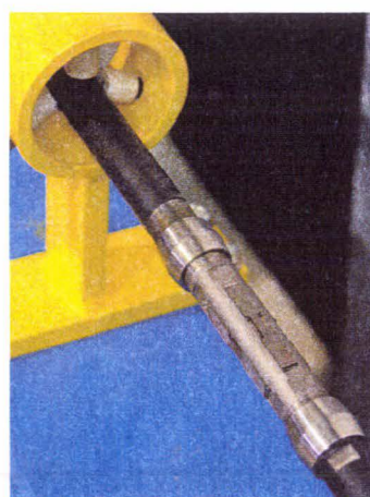
Figure A-8-2 : Montage de traction d'éprouvettes plates collées sur le dispositif aux barres de Hopkinson.
