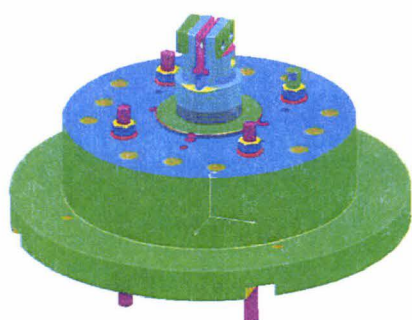
Figure 3-3 : Modèle C.A.O. de la partie inférieure du dispositif d'essais dynamiques.
