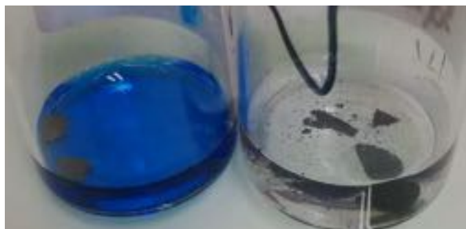
Figure 18- Solutions de test photo-catalytique sous UV pendant 2h : à gauche, mousse vierge, à droite, la mousse à photocatalyseur TiO 2 intégré : le bleu de méthylène se dégrade en particules noires insolubles.
