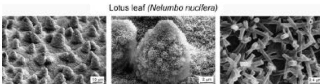
Figure 20- Surface de la microstructure d'une feuille de Lotus ( Nelumbo nucifera ) à trois échelles différentes.
