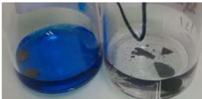
**Figure 18-** Solutions de test photo-catalytique sous UV pendant 2h : à gauche, mousse vierge, à droite, la mousse à photocatalyseur TiO<sub>2</sub> intégré : le bleu de méthylène se dégrade en particules noires insolubles.
