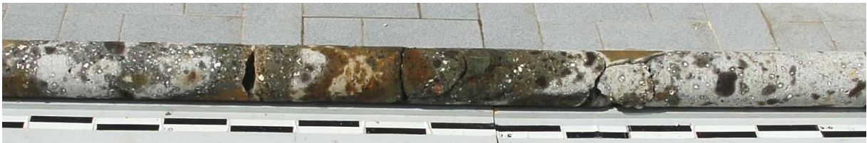
Figure 87 : béton Baia Sinus - sommet de la carotte était à 3,45 m sous le niveau de la mer, la profondeur du trou carotté était de 3,15 m et la longueur totale de la carotte récupérée était de 2,9 m.
