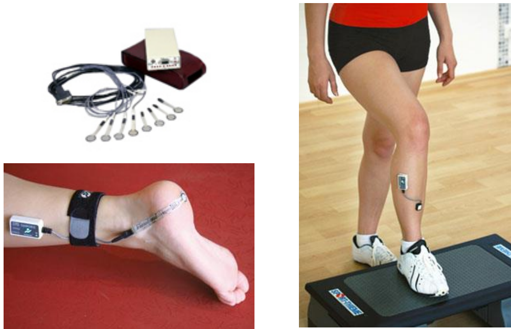
Figure 1-4 Contacteurs plantaires : Norswitch (gauche) et DTS Flexiforce (droite) [45]
