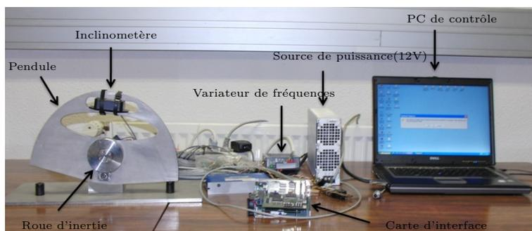
FIGURE 1.4 – La plate-forme expérimentale du PIRI
