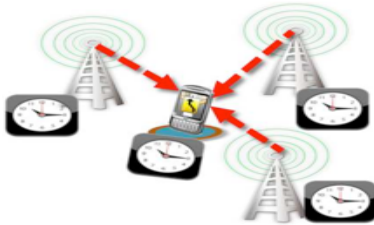
FIGURE B.2 – Principe du positionnement exogène.
