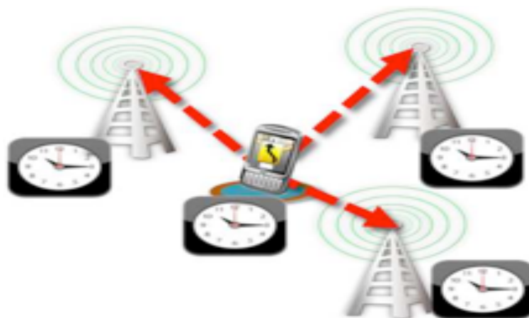
FIGURE B.1 – Principe du positionnement endogène.
