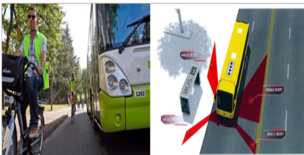
FIGURE 3.1 – Interaction entre les cyclistes et le bus, les angles morts du bus.
