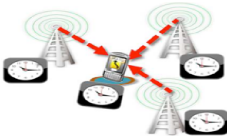
FIGURE B.2 – Principe du positionnement exogène.
