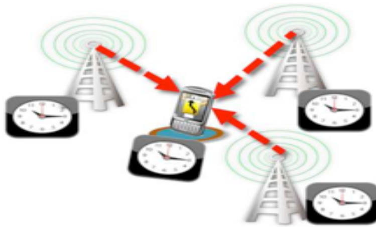
FIGURE B.2 – Principe du positionnement exogène.
