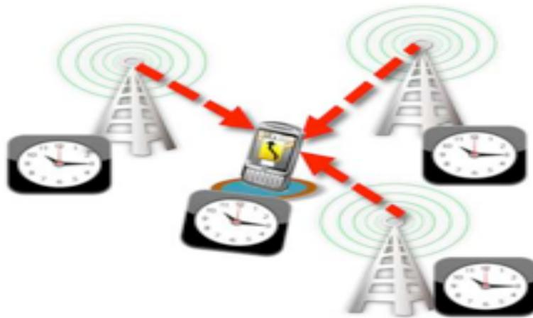
FIGURE B.2 – Principe du positionnement exogène.
