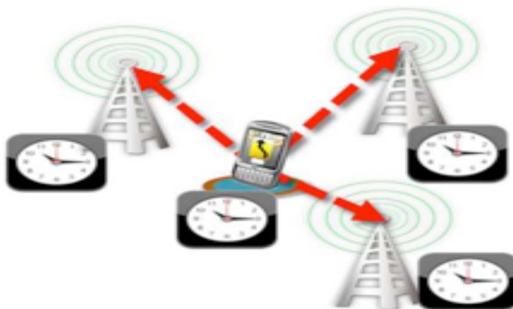
FIGURE B.1 – Principe du positionnement endogène.
