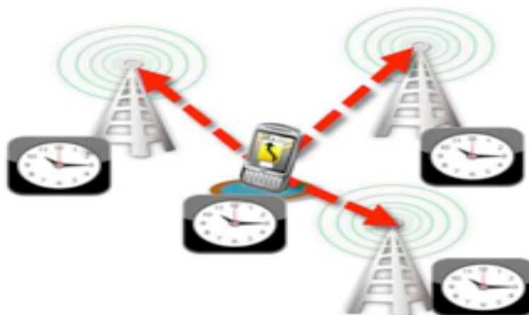
FIGURE B.1 – Principe du positionnement endogène.
