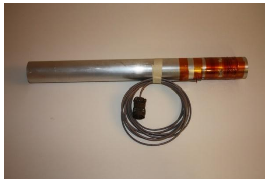
Figure 86: Tube instrumenté pour essais sur échantillons osseux.
